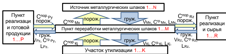
Рис.1. Схема математической модели определения основных параметров потоков сырья при переработке и утилизации металлургических шлаков
