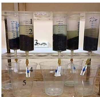
Рис. 1. Лабораторная установка перколяционного выщелачивания:
