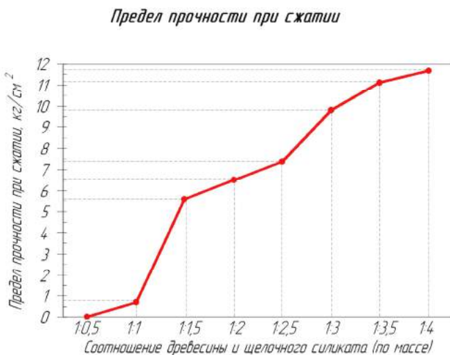
Рис.3. Предел прочности при сжатии образцов теплоизоляционного материала
