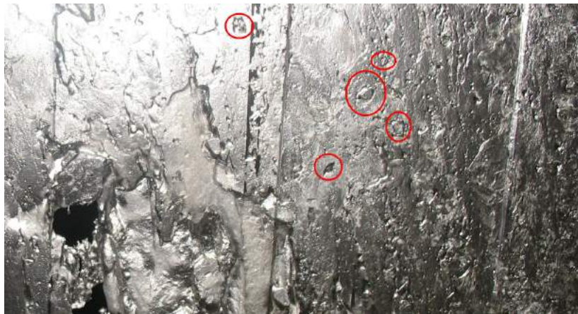
Рис.2. Фрагмент анода №1 с дефектами шарообразной формы
