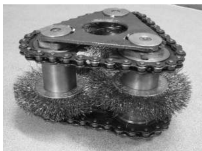
Рис. 2. Корпус планетарного механизма (а) и иголфрезерный узел (б)
