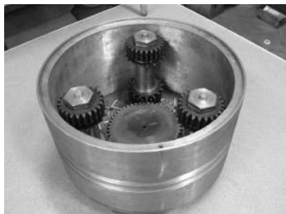
Рис. 2. Корпус планетарного механизма (а) и иголфрезерный узел (б)
