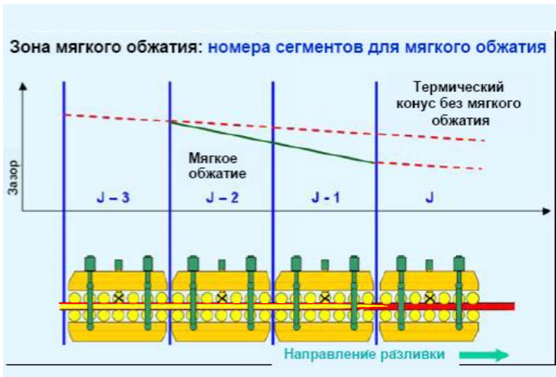
Рис. 3. Схема выбора сегментов для осуществления мягкого обжатия непрерывнолитой слябовой заготовки
