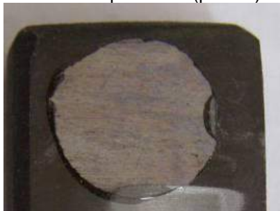
Рис. 2. Состояние поверхности образца после отрыва оксидного слоя
