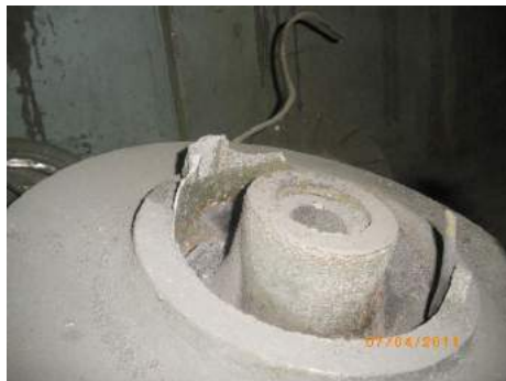
Рис.7. Залив, образовавшийся между стержнями
