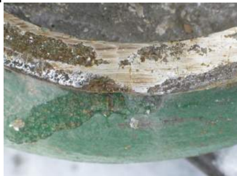
Рис.6. Газовые раковины на поверхности отливки
