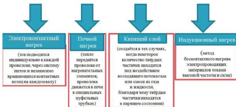
Рис. 4. Диффузионный нагрев медно-цинкового покрытия на проволоке
