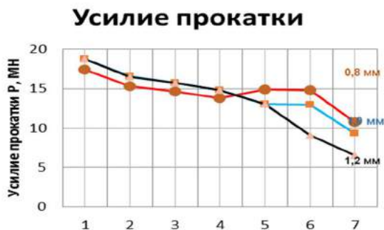
Рис. 2. Распределение усилия прокатки по клетям
