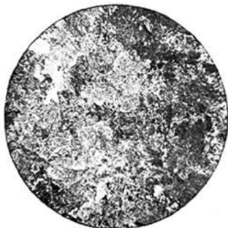
Рис. 2. Структура проволоки после отжига первого рода в печи кипящего слоя СПОК 1,8.20. Количество перлита первого балла 80–85%
