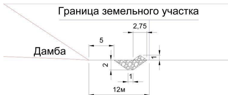
Рис. 2. Сечение водосборной канавы
