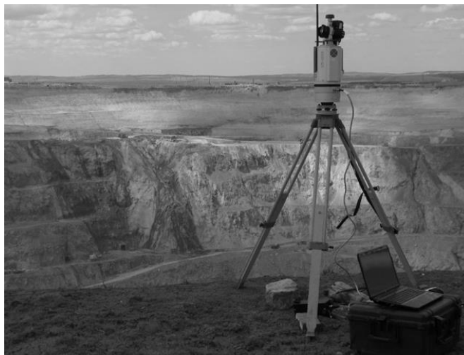
Рис. 5. Лазерный сканер с системой спутникового позиционирования
