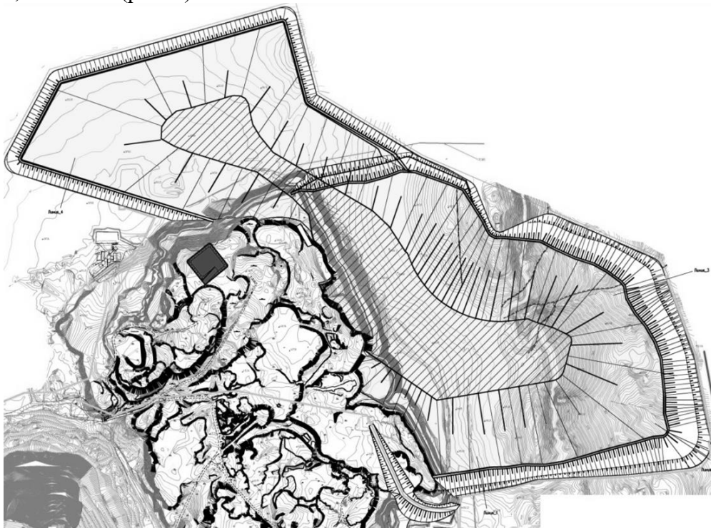
Рис. 8. Ограждающая дамба Центрального и Северного отсеков
