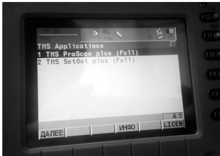
Рис. 2. Электронный роботизированный тахеометр Leica TCRA1202+ с установленным на нём программным обеспечением TMS ProScan plus и TMS SetOut plus
