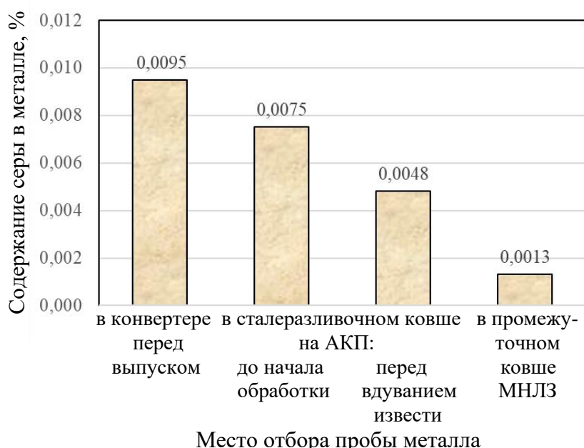
Рисунок 3 – Усредненные данные о содержании серы в металле на разных этапах производства стали марки DNV SAWL 485 FD
