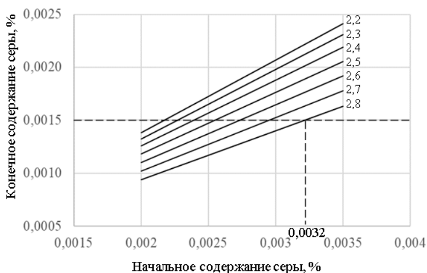
Рисунок 8 – Расчетные значения конечного содержания серы в зависимости от ее начального содержания и удельного расхода флюидизированной извести (цифры у линий, кг/т)
