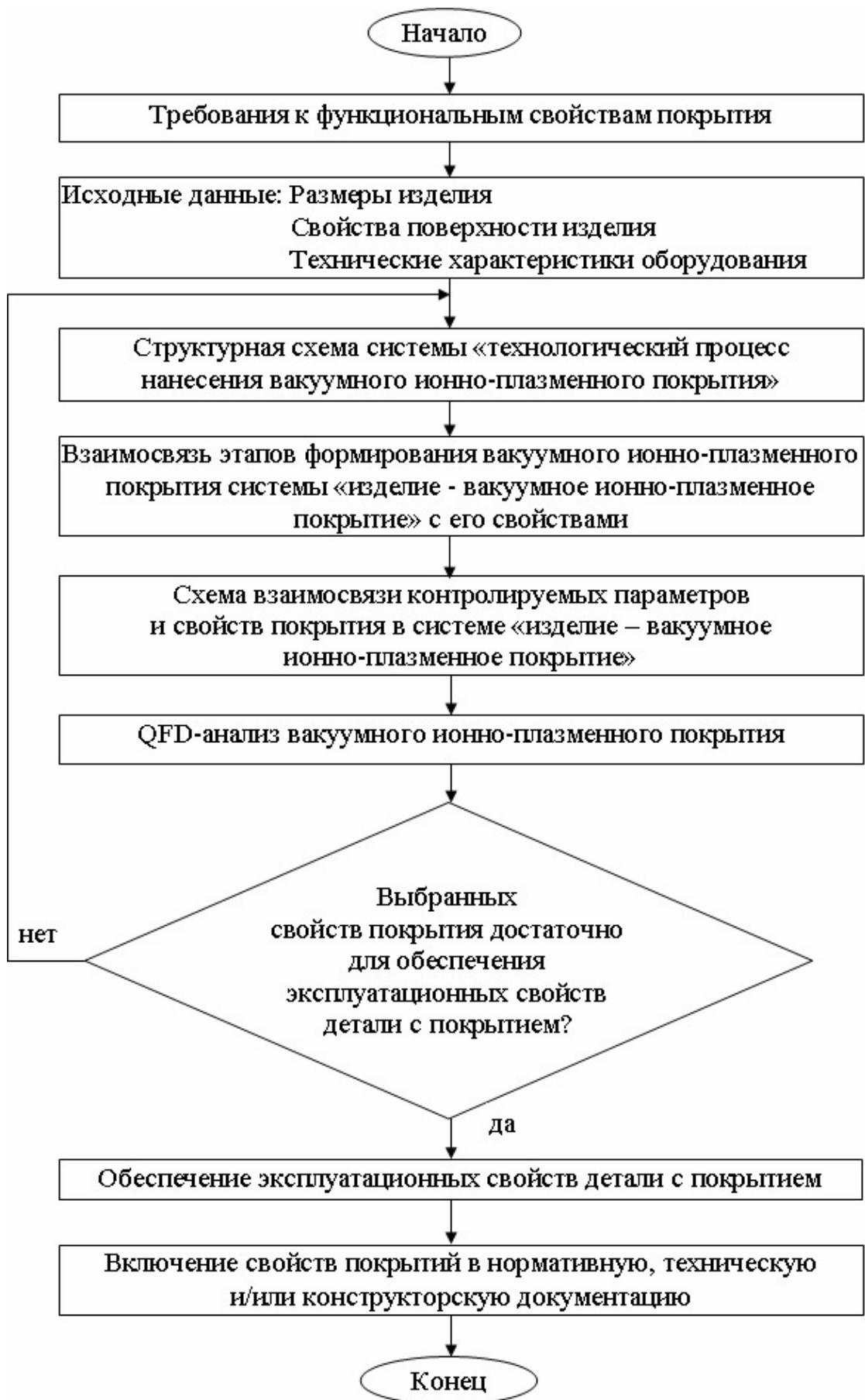
Рисунок 7 – Алгоритм выбора свойств вакуумного ионно-плазменного покрытия для регламентации в нормативной, технической и/или конструкторской документации
