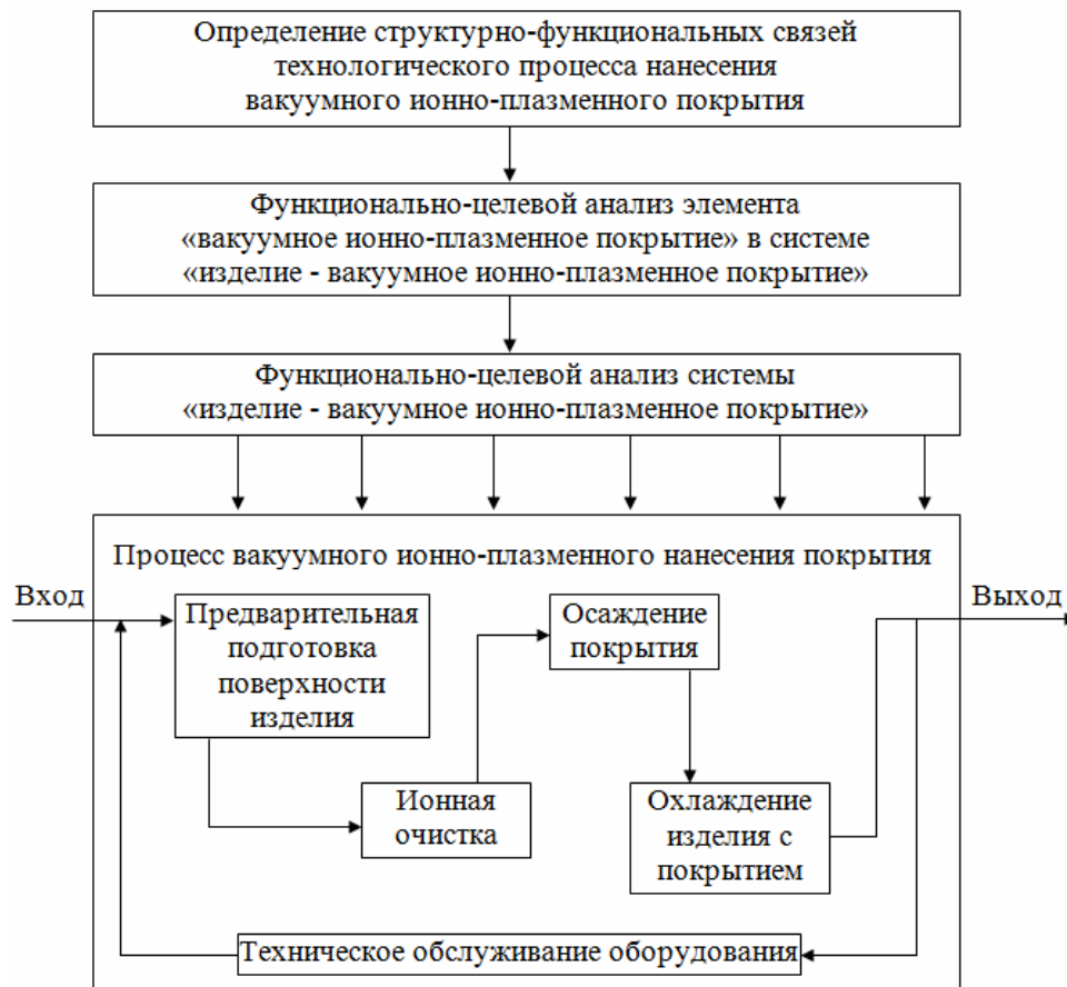
Рисунок 2 – Обобщенная схема установления системных связей в системе «изделие - вакуумное ионно-плазменное покрытие»
