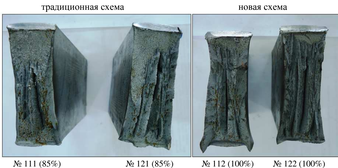
Рис. 3.34. Вид изломов образцов, изготовленных по ТУ 14-101-725-2009
