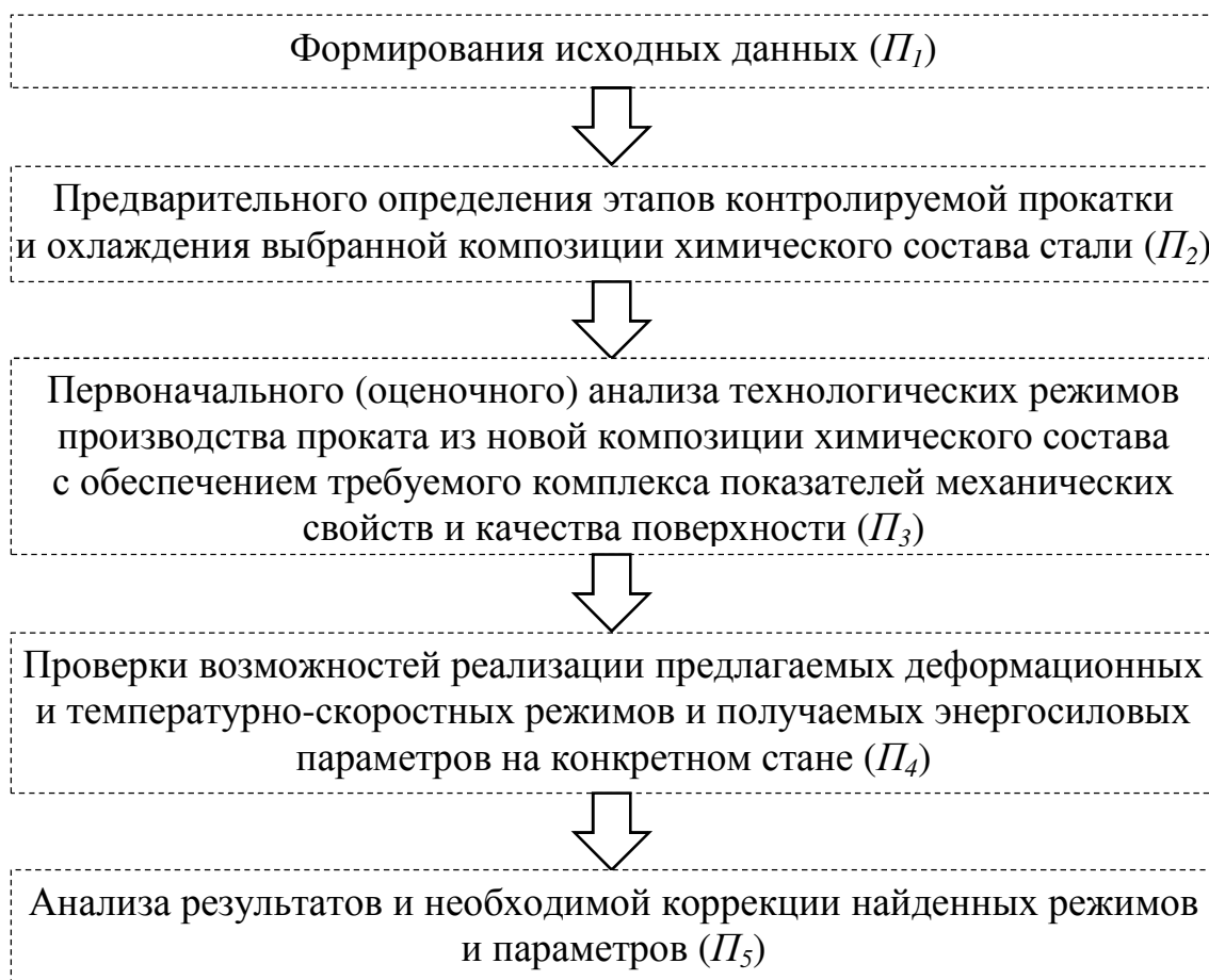
Рис. 1.28. Специализированная исследовательская система проектирования новых технологий прокатки низколегированной стали
