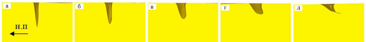
Рис. 4.28. Трансформация поперечной кромочной трещины (сечение АА): а, б, в, г, д – форма дефекта после первого, второго, третьего, четвёртого, пя- того деформационного прохода соответственно (стрелкой показано направ- ление прокатки)
