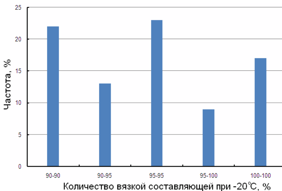
Рис. 3.30. Результаты испытаний пластических и вязкостных свойств ТЛП: а – относительного удлинения; б – количества вязкой составляющей в изломе
