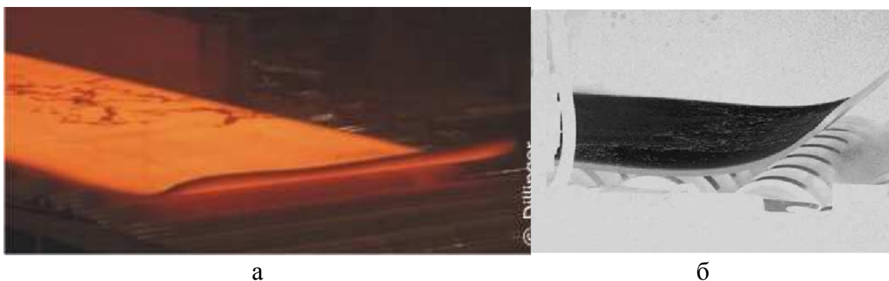
Рис. 5.5. Вертикальный изгиб переднего участка ТЛП (а) и форма раската при повышенных значениях кривизны (б)
