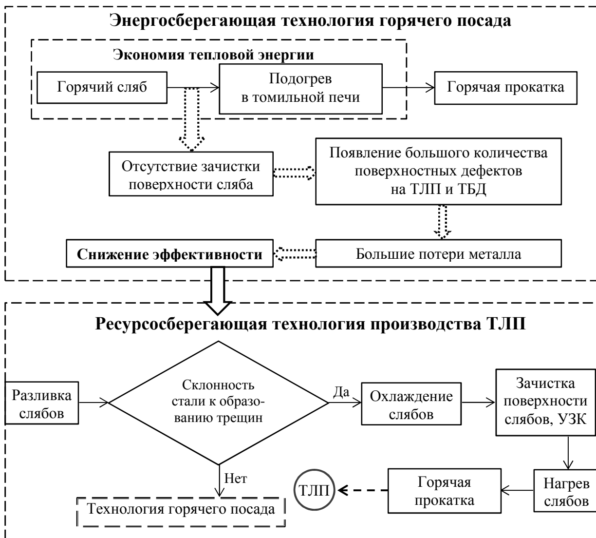
Рис. 1.18. Особенности применения технологии горячего посада в технологической системе «МЛТС-ТЛП»
