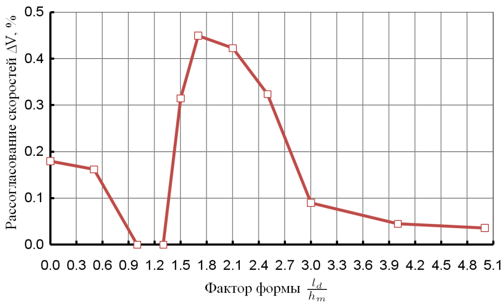
Рис. 5.42. Традиционный режим рассогласования скоростей рабочих валков (при температуре деформируемого металла 900°C)
