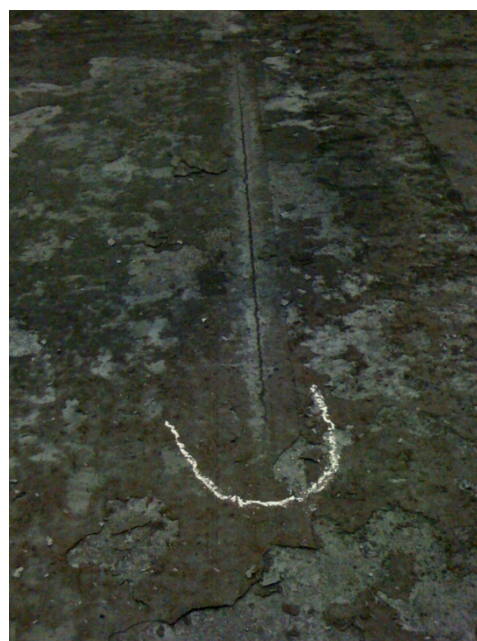
Рис. 4.11. Ребровая (а) и продольная осевая (б) трещины на верхней грани сляба из МЛТС категории прочности К60
