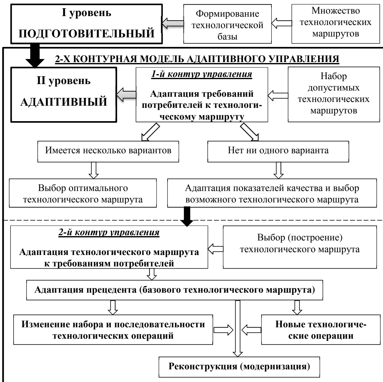
Рис. 1.31. Двухуровневая двухконтурная система адаптивного управления качеством металлопродукции
