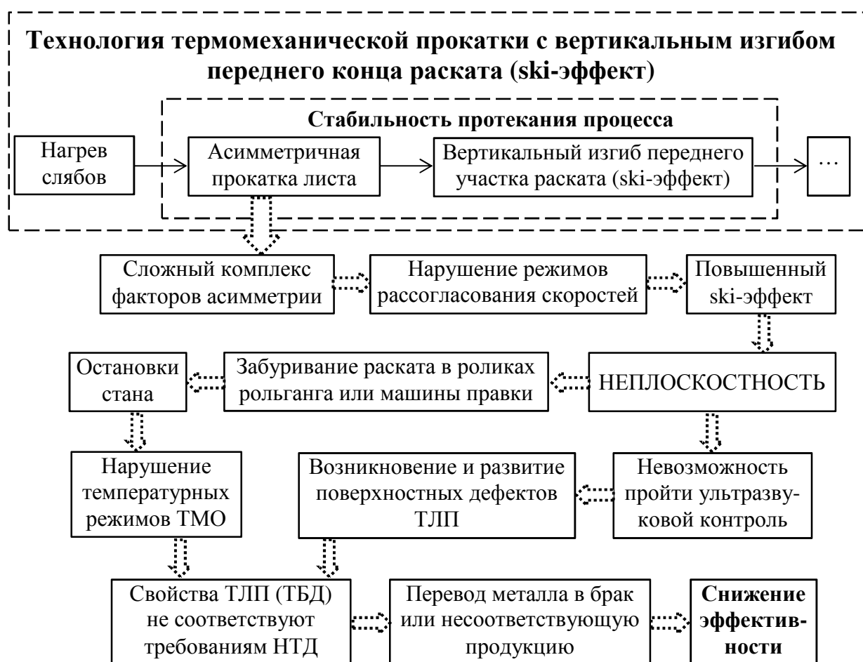
Рис. 1.21. Блок-схема технологии термомеханической прокатки с вертикальным изгибом переднего участка раската
