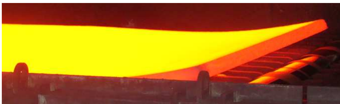
Рис. 5.18. Изгиб переднего участка черного раската на ТЛС 5000
