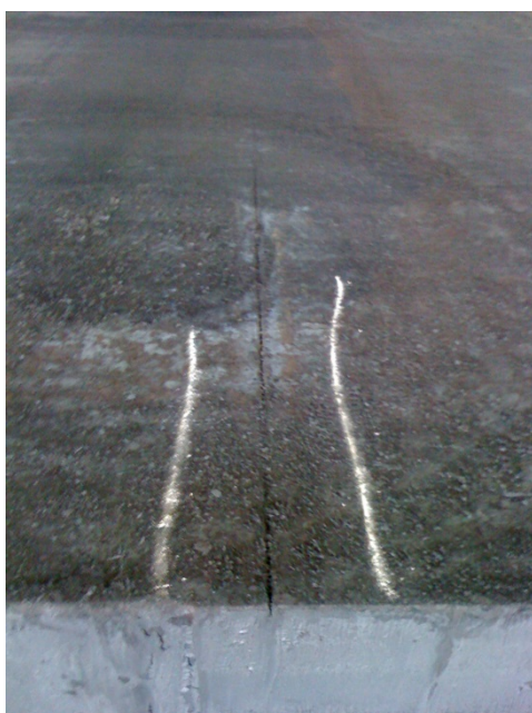
Рис. 4.11. Ребровая (а) и продольная осевая (б) трещины на верхней грани сляба из МЛТС категории прочности К60
