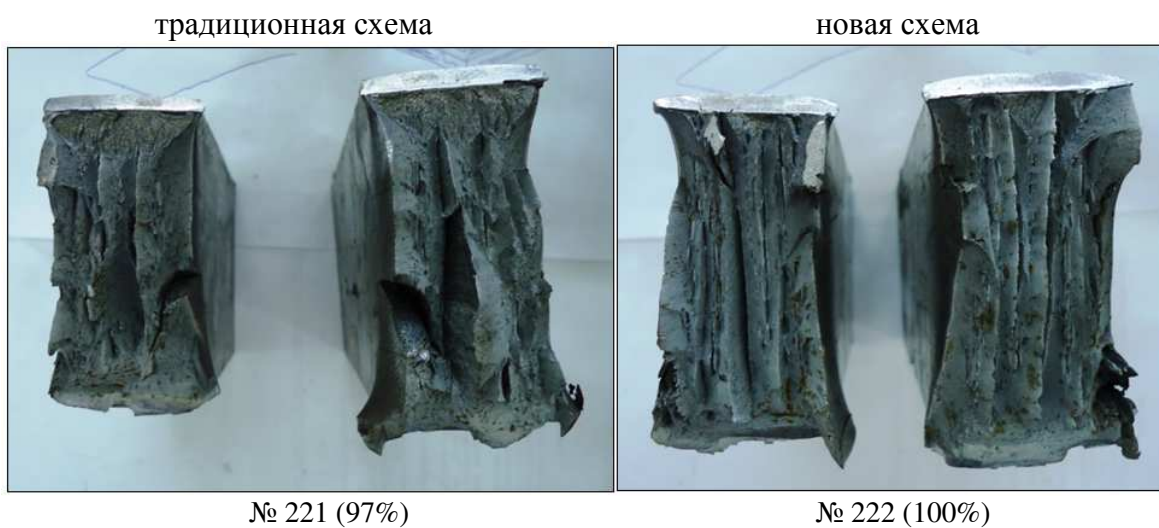
Рис. 3.36. Изломы образцов, изготовленных по ТУ 14-101-944-2013 (плавка 2)
