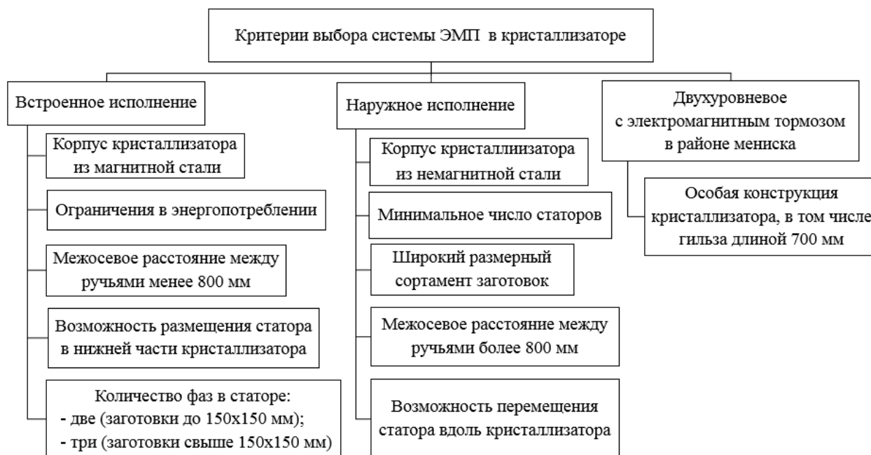
Рисунок 13 – Критерии выбора системы ЭМП в кристаллизаторе
