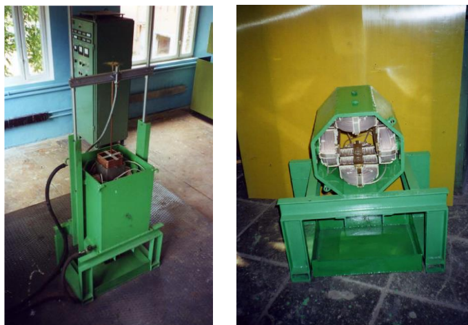
Рисунок 6 – Общий вид стенда (слева) и магнитопровода статора (справа) для физического моделирования МГД-процессов при ЭМП в кристаллизаторе
