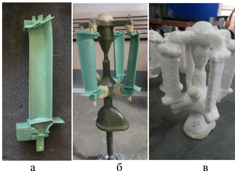
Рисунок 7 – Технологическая цепочка изготовления формы: а – модель лопатки; б – блок лопаток; в – керамическая форма
