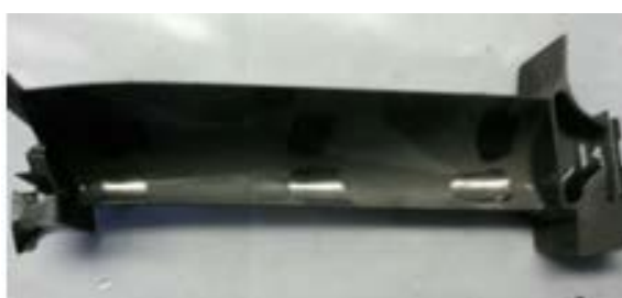
Рисунок 8 – Залитая лопатка ГТД
