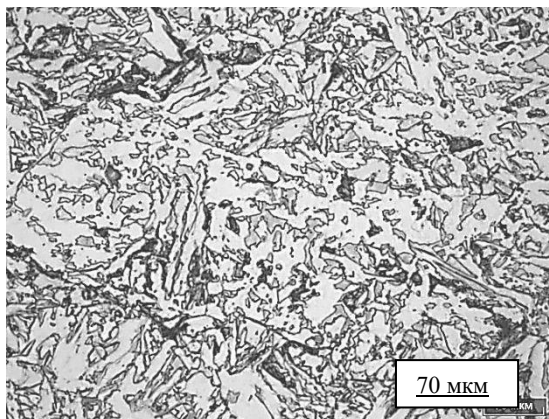
Рисунок 5.1 – Микроструктура стали марки 20Г2СМРА в исходном горячекатаном состоянии. Световая микроскопия, \times 200
