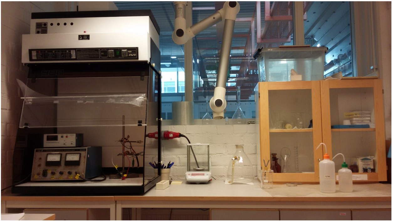
Рисунок 13. Рабочее место с установкой для проведения электролитического растворения.
