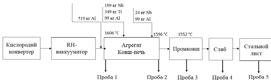
Рисунок 4. Схема отбора проб металла и технологии производства стали класса IF на предприятии 1.
