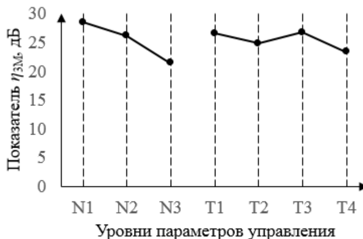
Рисунок 5.19 – Диаграмма эффектов параметров управления по показатель \eta_{ЗМ} (для разрывного усилия)
