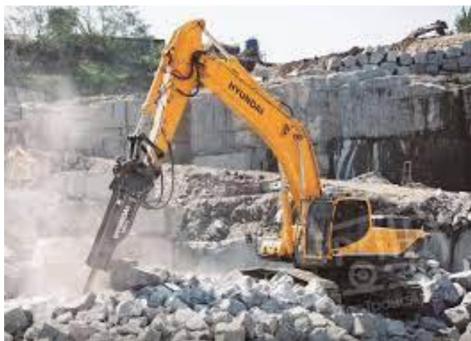
Рисунок 1.29 Подготовка мрамора к выемке с помощью тяжелого гидромолота фирмы «Volvo»
