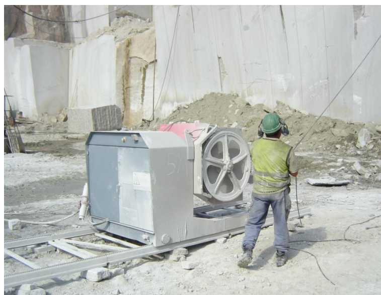
Рисунок 1.26 – Алмазно-канатная машина CWC 75 HPN ( Granite Ros мощность 55 кВт, диаметр ведущего шкива 810 мм)
