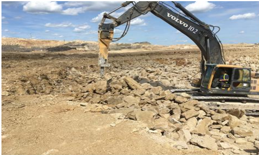
Рисунок 2.10 - Подготовка известняка к выемке с помощью тяжелого гидромолота фирмы «Volvo» на карьере ООО «Восточные Берники»
