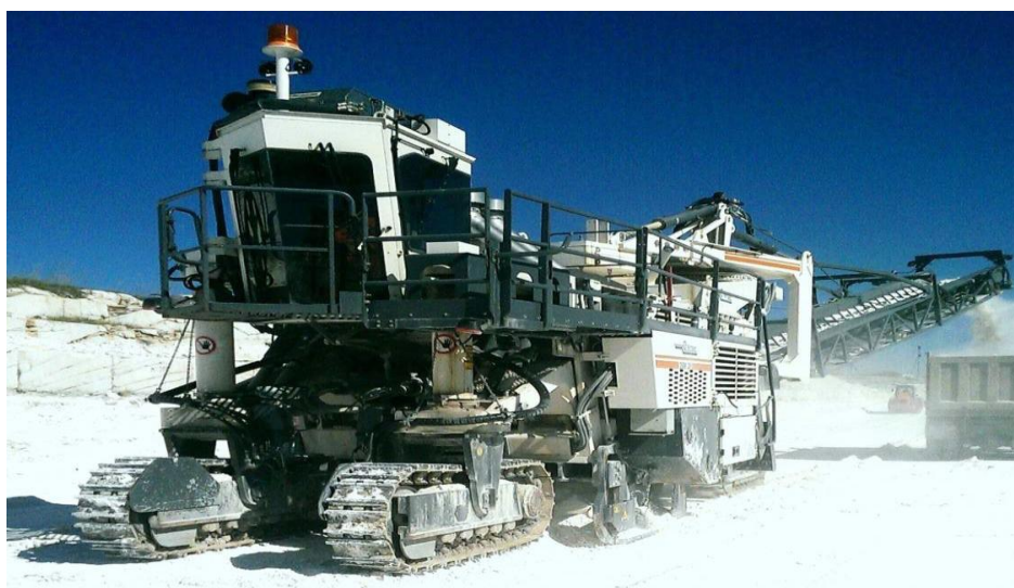
Рисунок 2.9 – Безвзрывная технологии горных работ с применением комбайнов Surface Miner фирмы Wirtgen GmbH:
