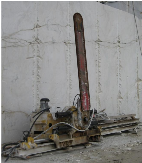
Рисунок 1.22 – Камнерезная баровая машина МКБ–1М (ЗИК) (завод им. М.И. Калинина)
