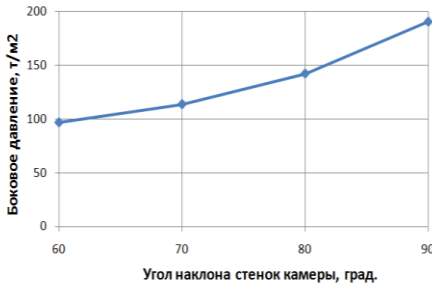
Рисунок 9 – Зависимость бокового давления сыпучей закладки от угла наклона камеры
