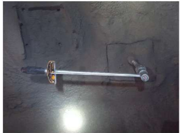
Рисунок 4.29. Испытание адгезии торкрет-бетона с породным массивом: а — подготовленная для испытания поверхность; б — вид установленных рамок для определения адгезии
