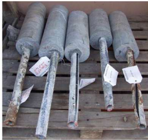
Рисунок 4.32. Корродированные образцы выбуренных анкеров после эксплуатации
