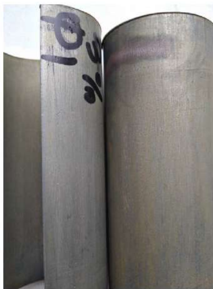
Рисунок 4.42. Общий вид стержня анкера после химической подготовки поверхности.
