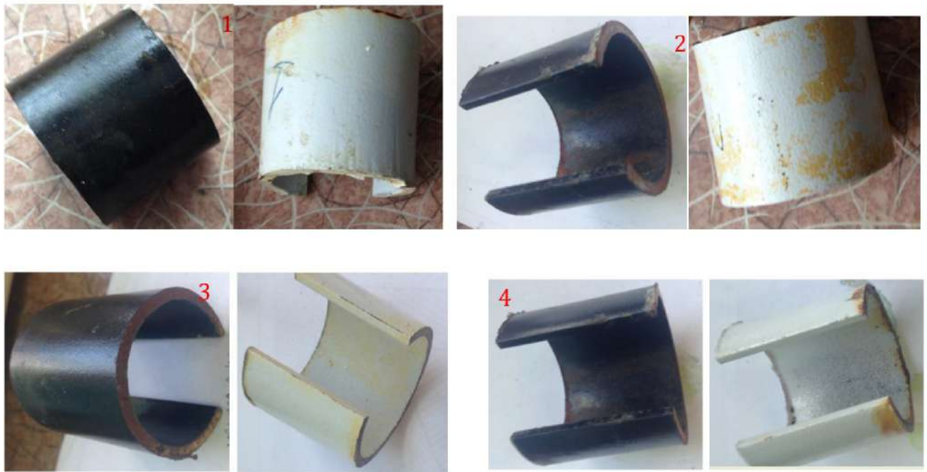
Рисунок 4.37. Состояние образцов с эпоксидным и эпоксиполиэфирным покрытием после проведения эксперимента по воздействию: 1 — водопроводной воды; 2 — кислой подотвальной воды; 3 — шахтной воды \text{pH} = 8,1 ; 4 — раствора солей \text{pH} = 7,5-8,5
