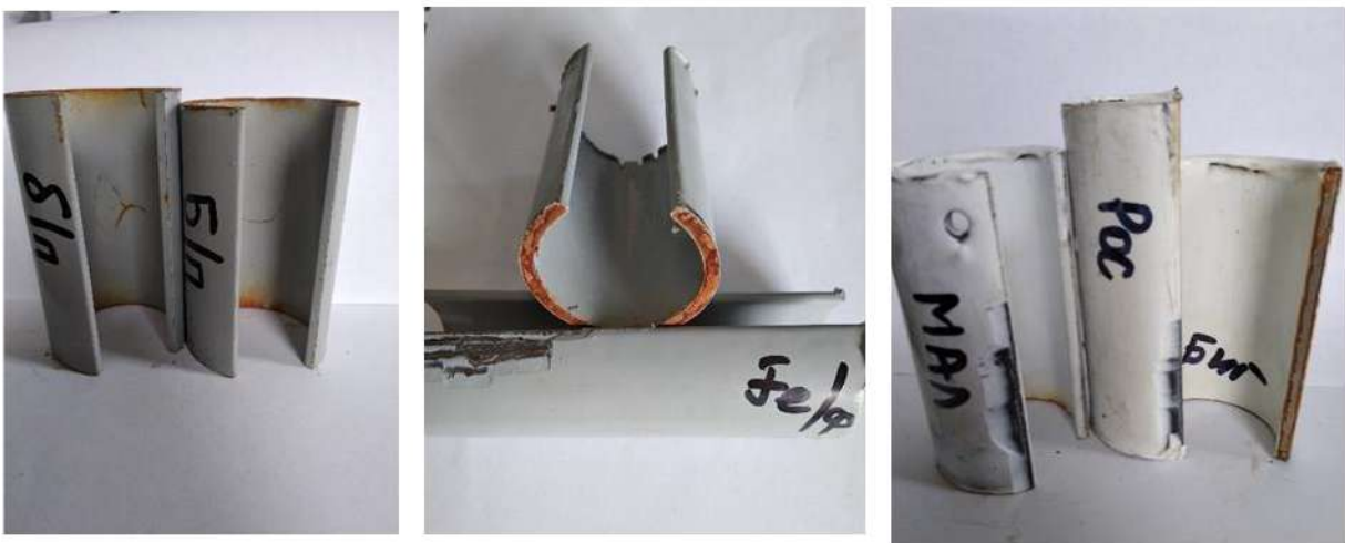
Рисунок 4.40. Образцы анкеров с адгезивными полимерными покрытиями
