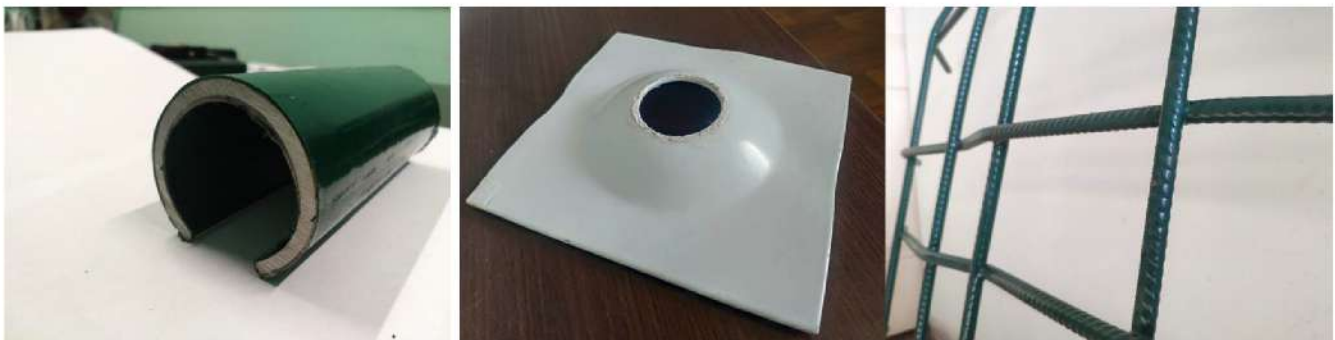
Рисунок 4.43. Состояние элементов анкерного крепления СЗА с защитным антикоррозионным покрытием на основе полимеров
