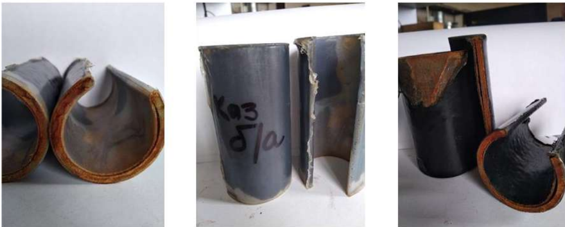
Рисунок 4.39. Образцы анкеров без предварительной подготовки с применением безадгезивных полиэтиленов
