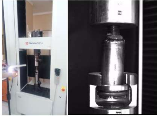
Рисунок 4.16. Испытания элементов СЗА в разрывной машине: а — общий вид; б — оснастка
