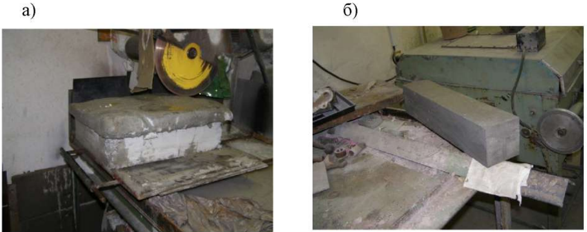
Рисунок 4.31. Подготовка образцов для испытания прочности: а — распиловка на сжатие; б — общий вид распиленной балки для оценки прочности на растяжение
