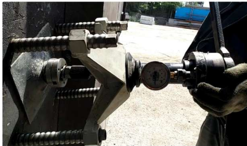
Рисунок 4.46. Общий вид прибора для определения несущей способности анкера с узлом захвата и центрирующей опорой
