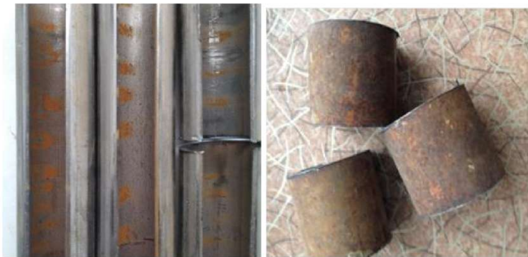
Рисунок 4.41. Возникновение очагов коррозии профиля в состоянии поставки (а) и лежалый (б) при нахождении на открытом воздухе
