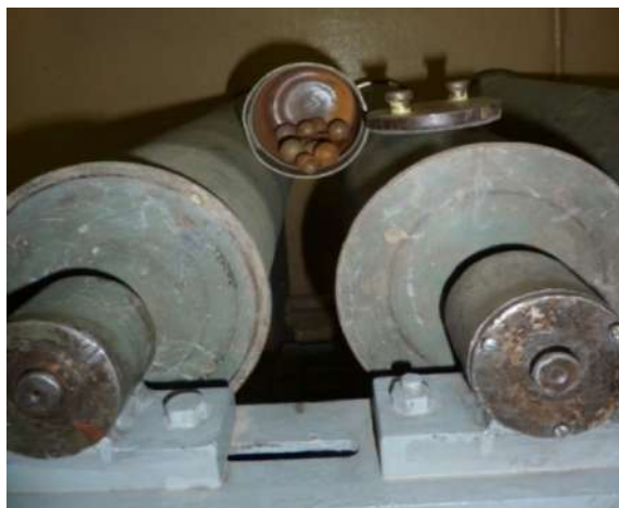
Рисунок 3.1 – Лабораторная шаровая мельница
