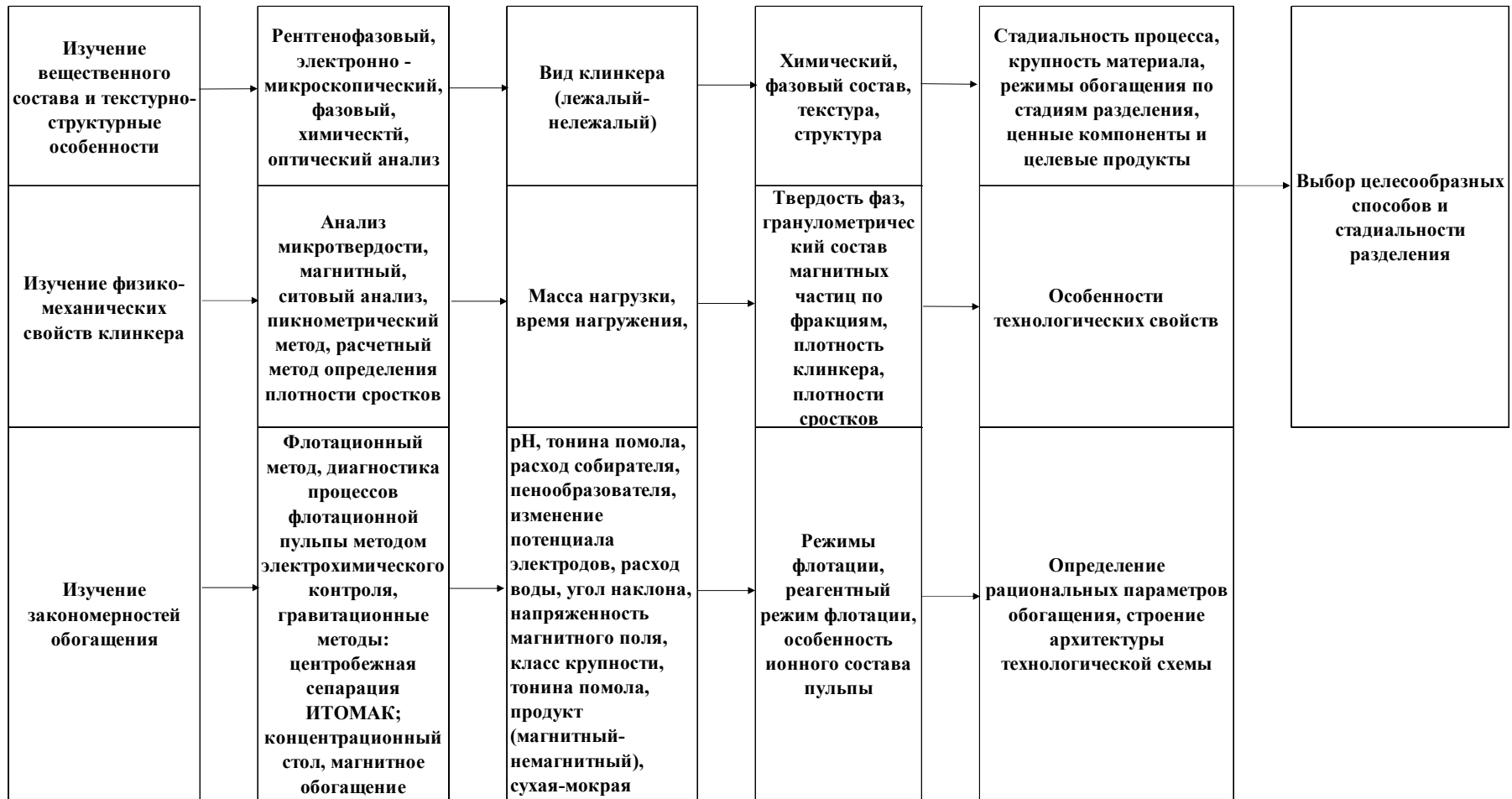
Рисунок 5.1 – Основные этапы экспериментальных исследований по разработке комбинированной технологии обогащения клинкера вельцевания ЧЦЗ
