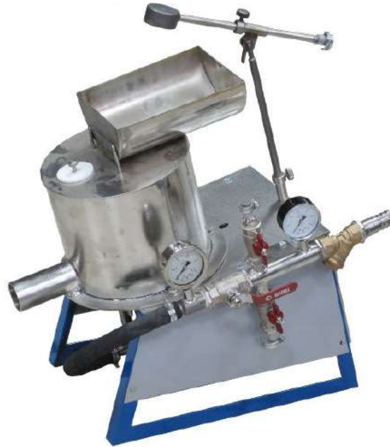
Рисунок 3.6 – Центробежный сепаратор ИТОМАК-КН-0,1
