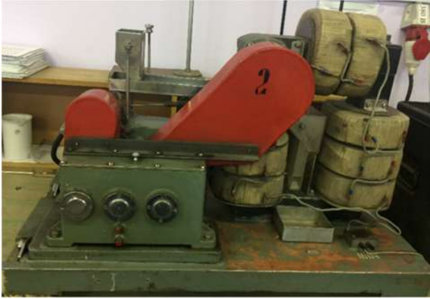
Рисунок 3.2 – Электромагнитный роликовый сепаратор 138Т-СЭМ
