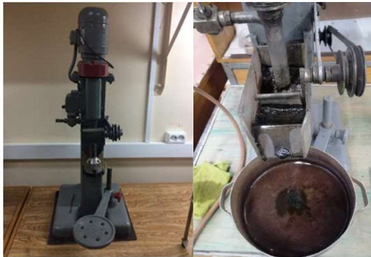
Рисунок 3.7 – Лабораторная флотационная машина
