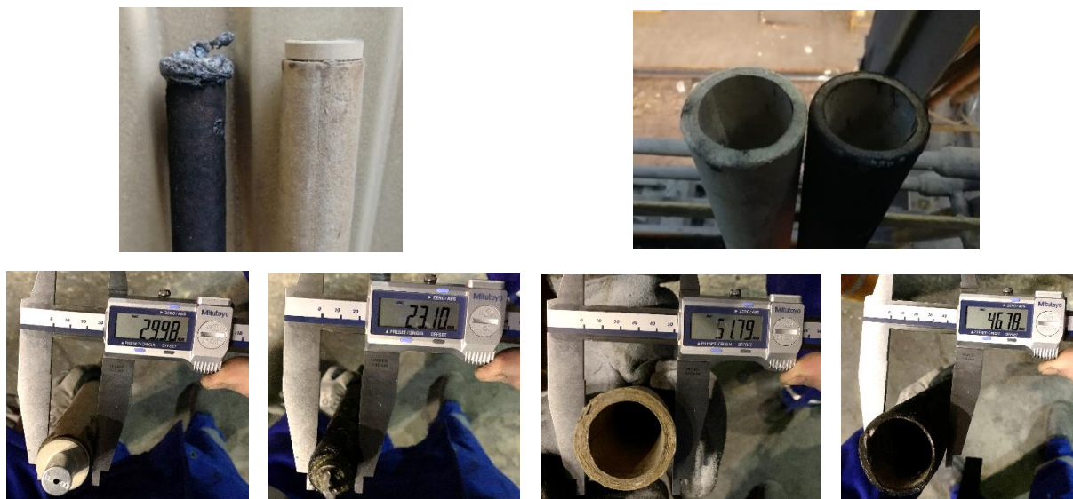
а) Бумажная гильза термопары до использования и после б) Бумажная гильза пробоотборника до использования и после
