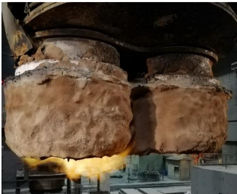
Рисунок 45 – Нанесение торкретирующей массы на патрубки вакуумкамеры между кампаниями выплавки низкоуглеродистого сортамента
