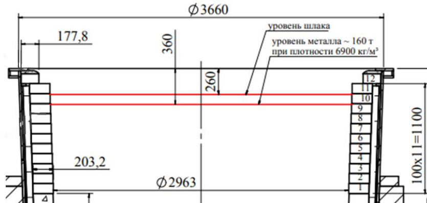
Рисунок 42 – Фрагмент чертежа сталеразливочного ковша
