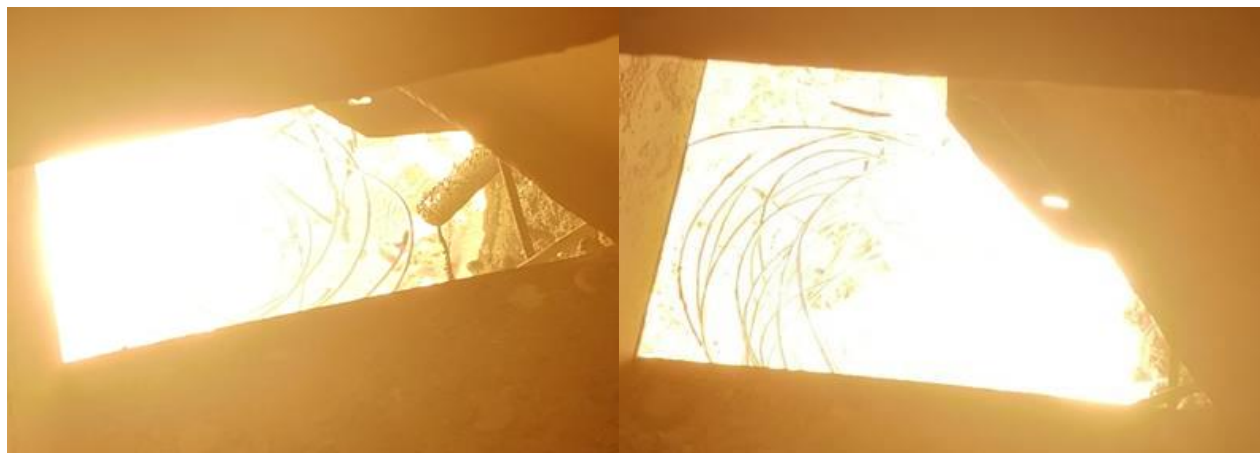
Рисунок 64 – Подъем нераскрывшейся порошковой проволоки на поверхность металла при средней скорости подачи 1,0 м/с
