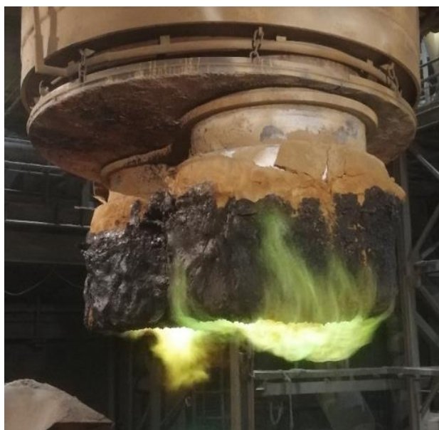
Рисунок 50 – Прогрев вакуумкамеры перед приемом кампании динамных марок сталей
