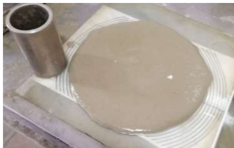
Рисунок 3. 10. Определение подвижности закладочной смеси по методу Суттарда
