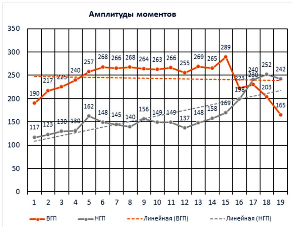
Рисунок 4.4 – Амплитуды упругих моментов шпинделей ВГП и НГП за 19 проходов, показанных на рисунке 4.1
