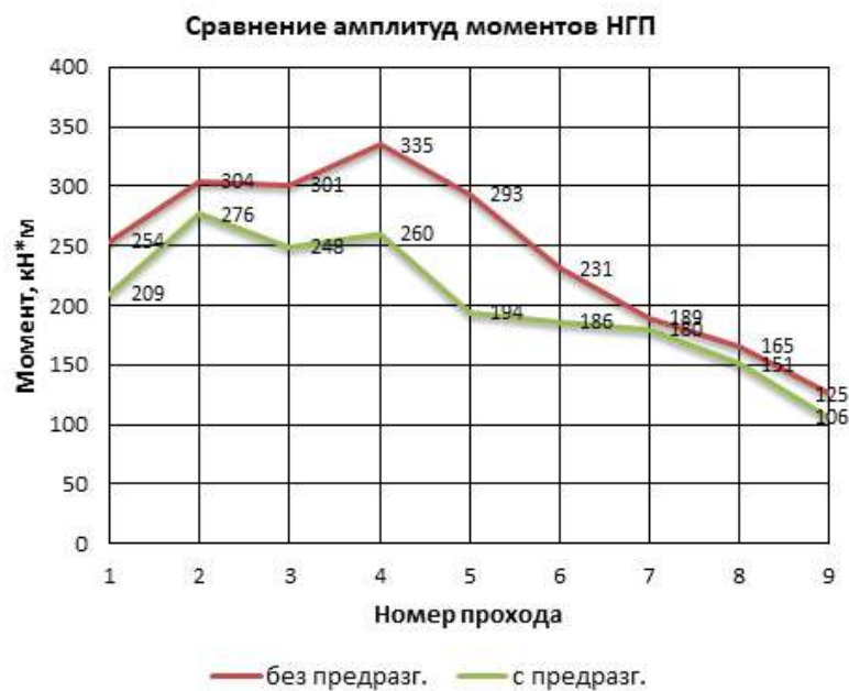
Рисунок 5.8 – Амплитуды моментов на шпинделях при прокатке с предразгоном (согласно [70]) и с внедренным алгоритмом для шпинделя ВГП (а) и для шпинделя НГП (б)
