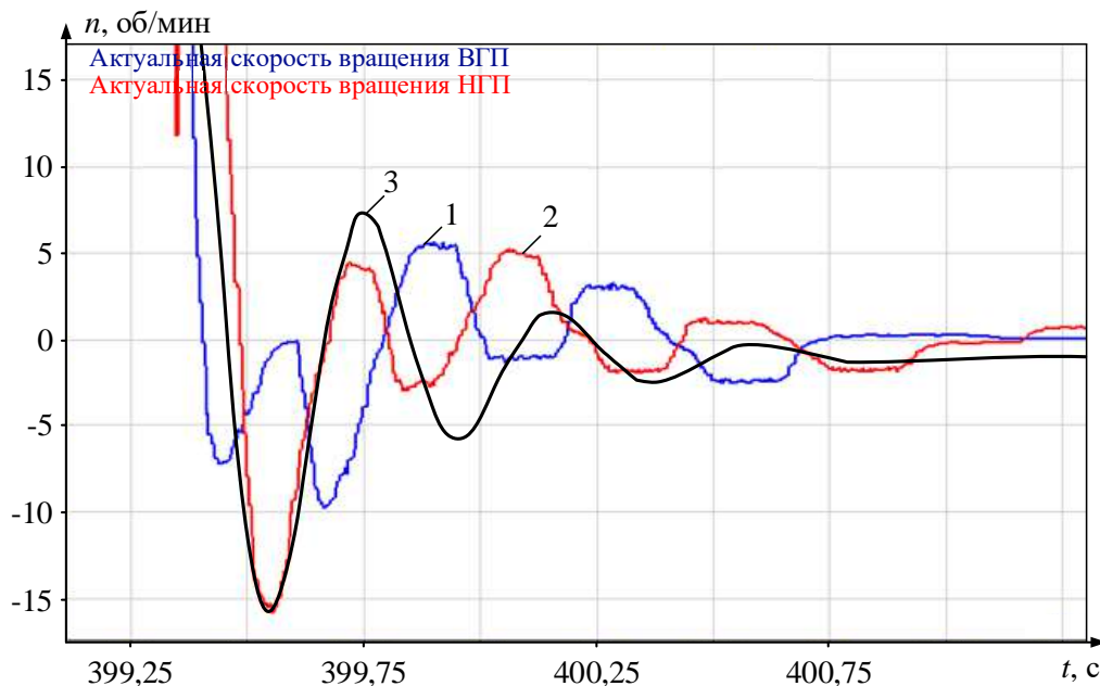
Рисунок 2.2 – Осциллограммы скоростей ВГП и НГП (1, 2) электроприводов при аварийном отключении; 3 – результат моделирования
