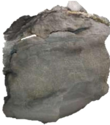
Рисунок 3.17 – Хром азотированный, полученный методом СВС в спутном потоке
