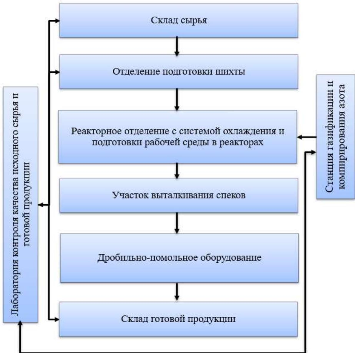
Рисунок 2.3 – Структурная схема для реализации метода СВС
