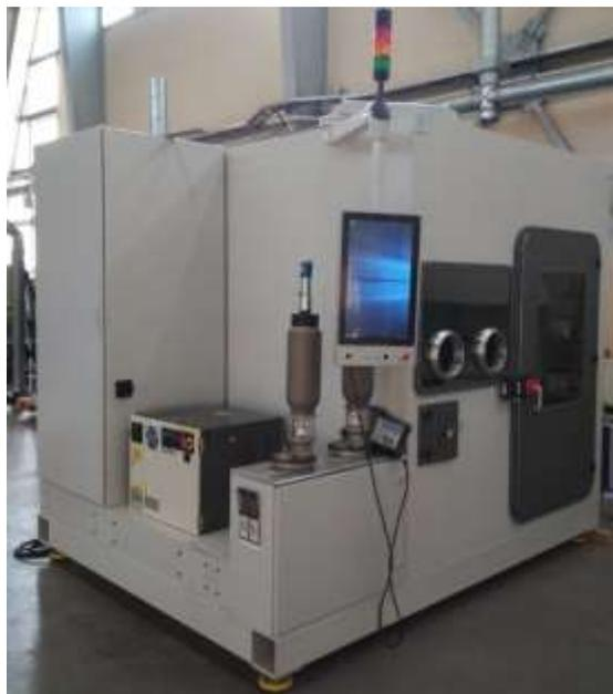
Рисунок 4.8 – Установка лазерного выращивания металлических деталей ИЛИСТ
