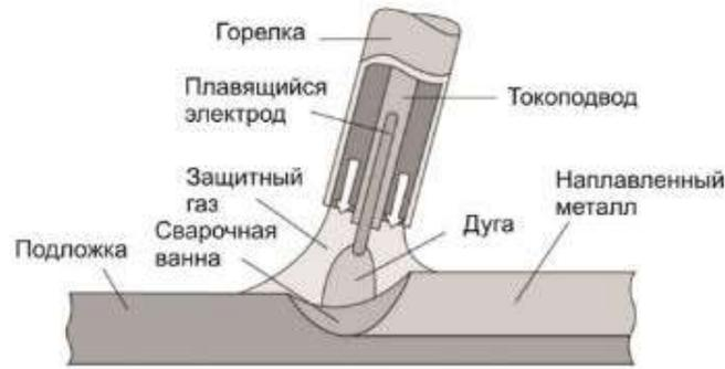
Рисунок 4.4 – Принципиальная схема WAAM-технологии печати [28]
