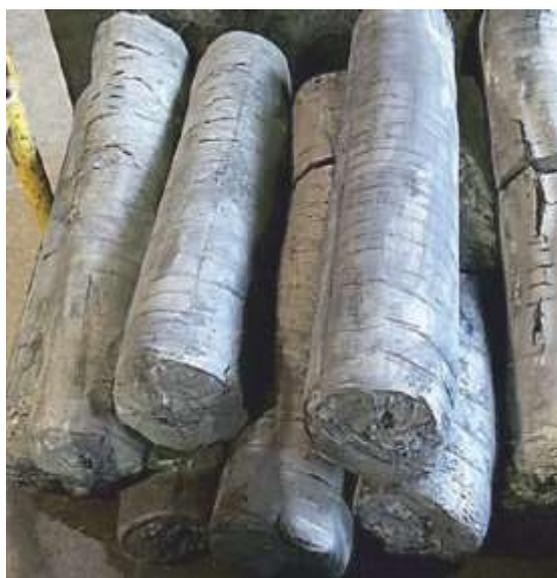
Рисунок 3.9 – Промышленные образцы спеченного нитрида хрома
