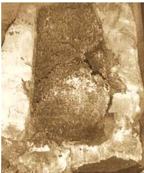
Рисунок 3.6 – Результат СВС-процесса в химической печи
