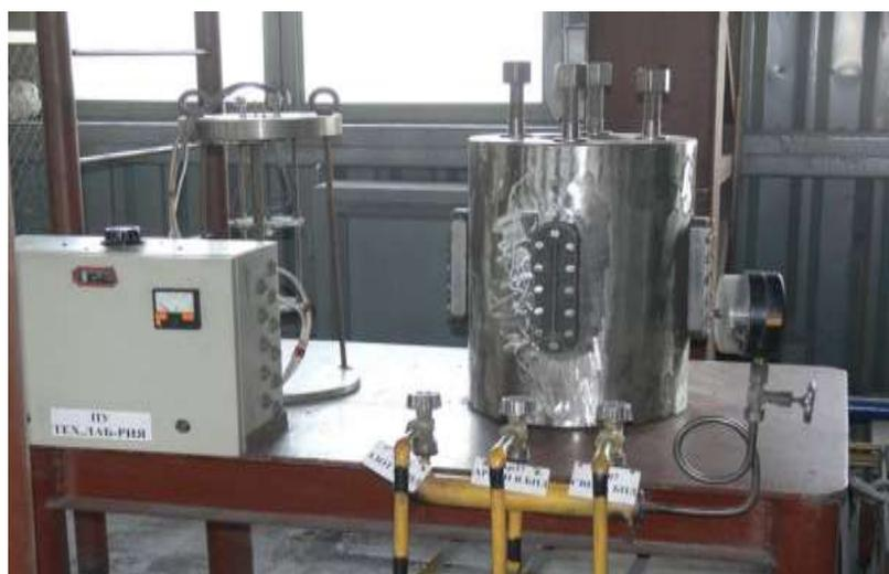
Рисунок 3.10 – Лабораторная СВС-установка «Бомба постоянного давления» объемом 15 л
