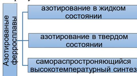
Рисунок 2 – Способы производства азотированных ферросплавов
