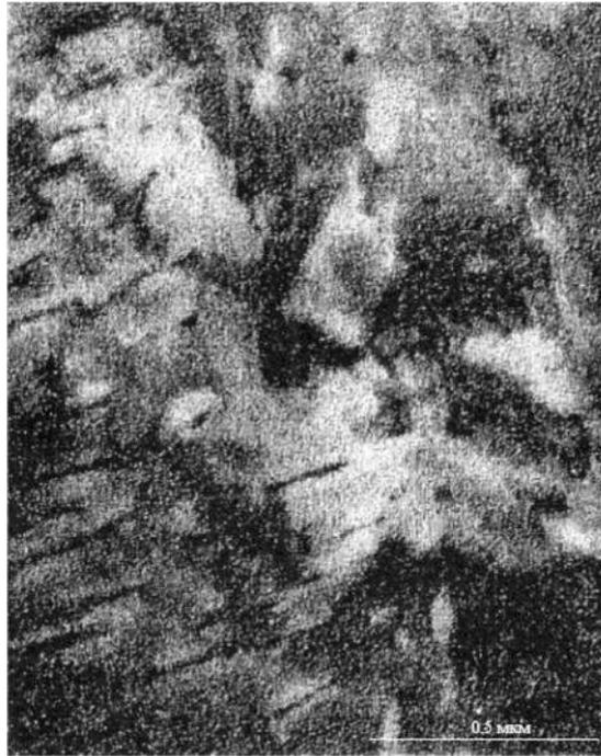
Рисунок 4.6 – Микроструктура стали 0X18A1.2 после закалки от 1200 °С и отпуска при 700°С
