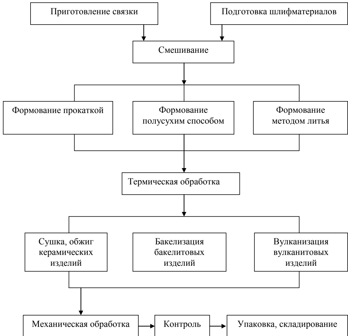
Рисунок 1 - Схемы технологических процессов производства абразивных инструментов на керамической, бакелитовой и вулканитовой связках
