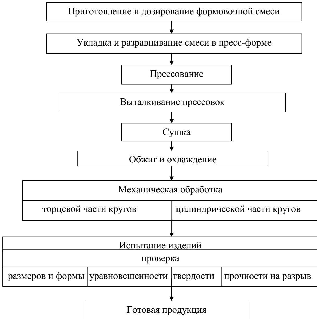
Рисунок 2 - Последовательность выполнения основных операций: дозирования, укладки, разравнивания и прессования смеси в пресс-форме, выталкивания прессовки и сушки, термической, механической обработки заготовок и испытания готовых кругов на керамической связке
