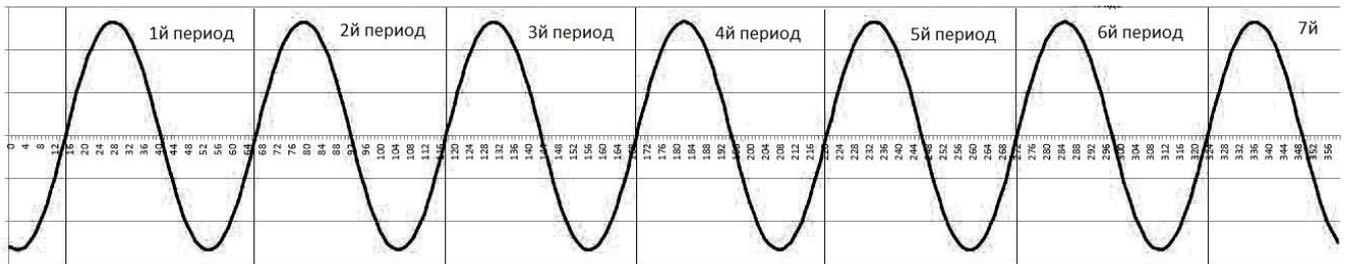
Рисунок 3.8 – Оригинальный сигнал тока, полученный с модели исправного СДПМ
