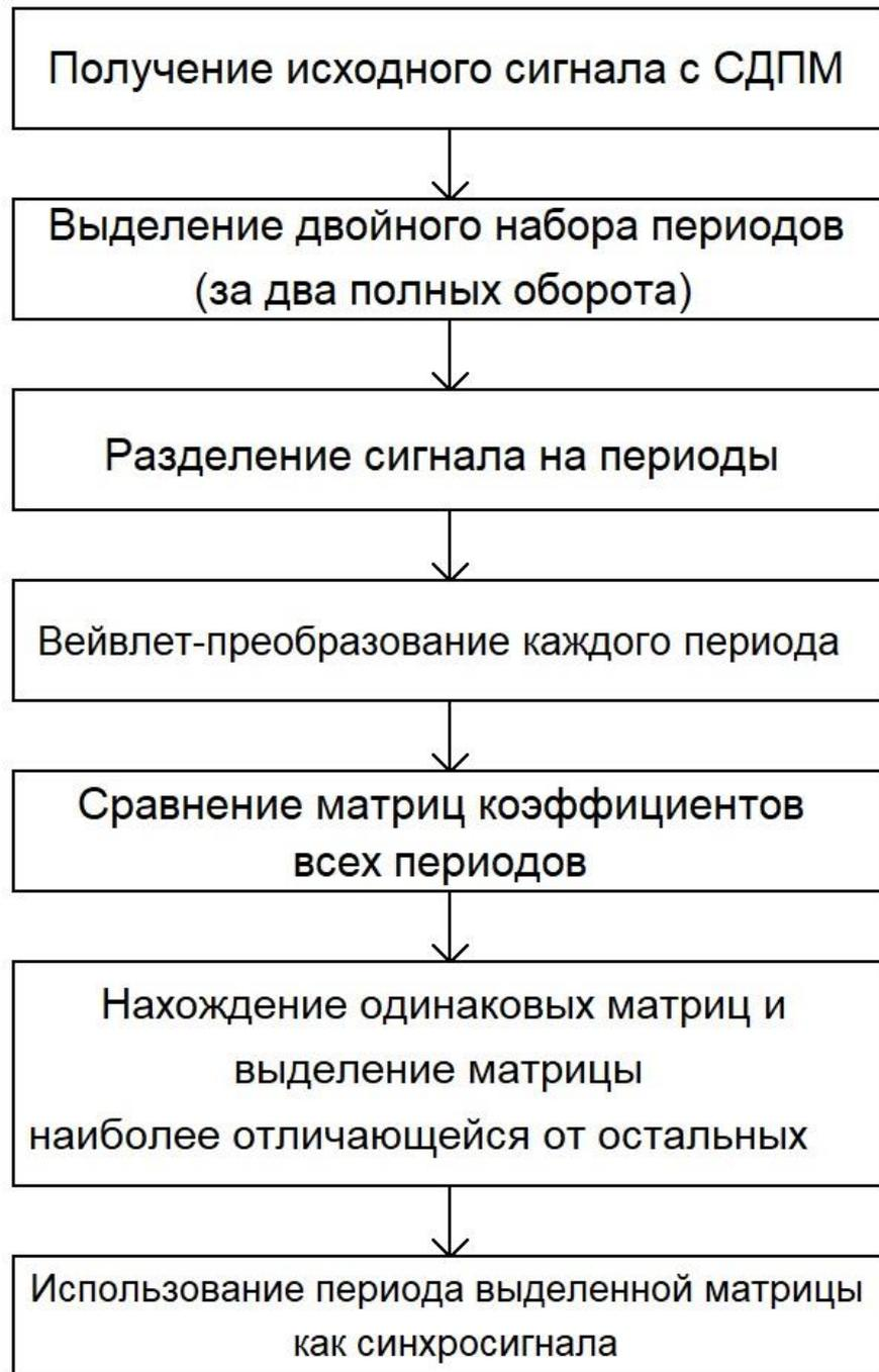
Рисунок 3.10 – Способ синхронизации для получения данных из СДПМ
