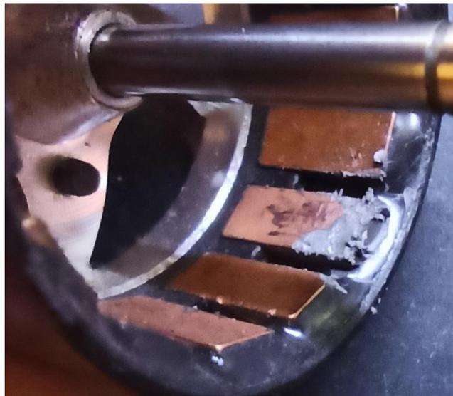
Рисунок 4.22 – Фотография СДПМ с неисправностью «крошение магнита»
