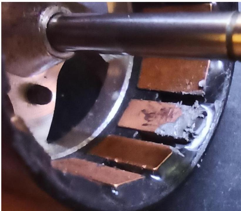
Рисунок 1.2 – Фотография СДПМ с неисправностью «крошение магнита»
