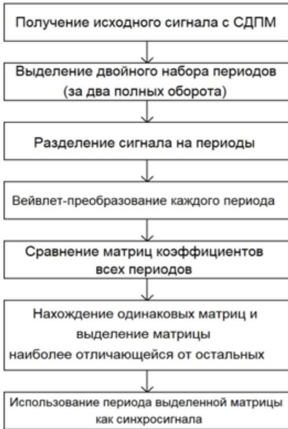
Рисунок 2 - Способ синхронизации сигналов тока СДПМ
