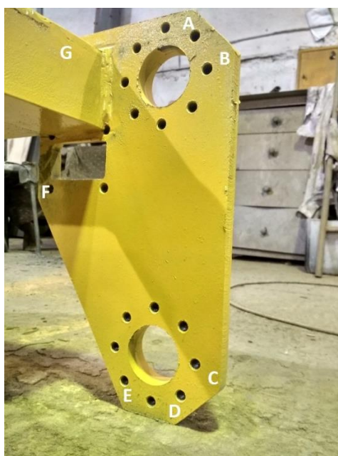
Рис. 3. Задняя щека каретки с обозначением рёбер
