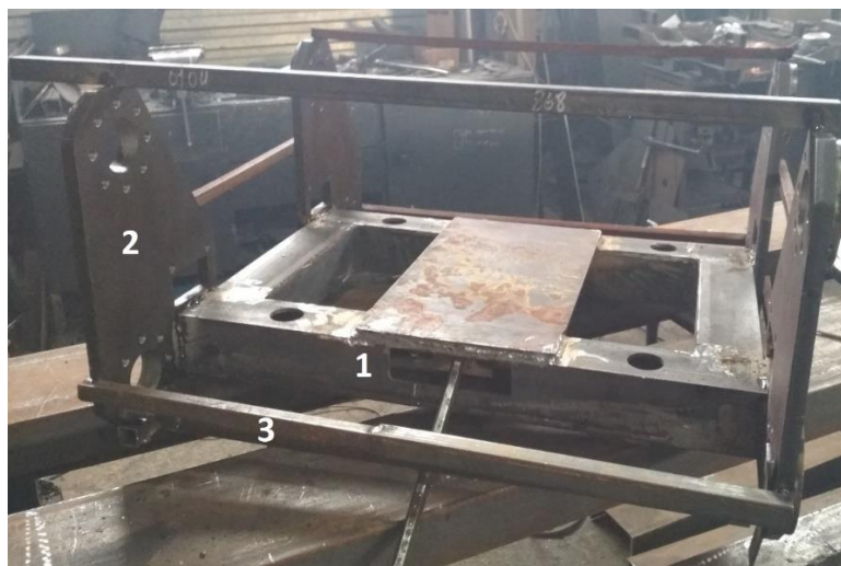
1 – рама каретки; 2 – щёки; 3 – технологические вставки Рис. 1. Каретка вращателя буровой установки с технологическими поперечинами
