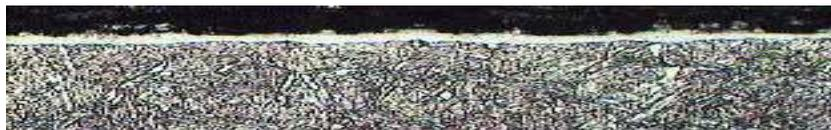
Белый слой твердого карбонитрида на поверхности детали
