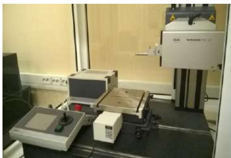
Рис.1 «Стилусный» профилометр XR20 (Mahr)
