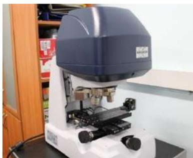
Рис. 2 Оптический профилометр Contour GT K1 (Bruker)
