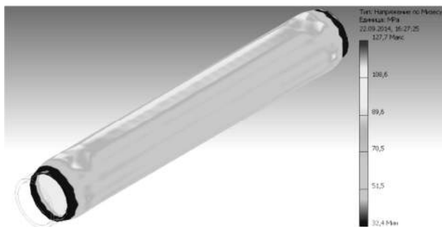
Рис. 2. Напряженное состояние гильзы гидроцилиндра в исходной конструкции
