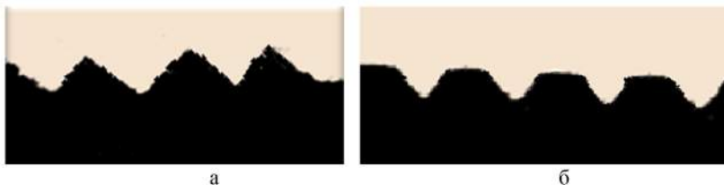
Рис. 2. Профиль неровностей (увеличение \times 400 ): а – исходный профиль; б – после обработки ППД
