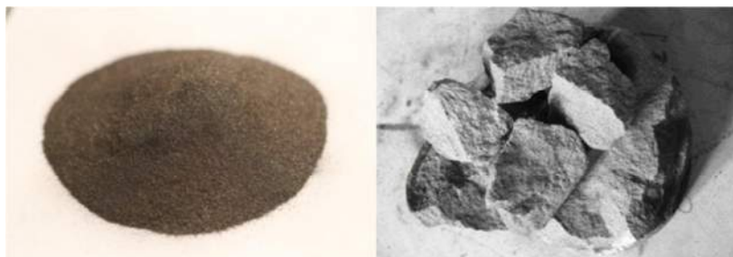
Рис. 2. Внешний вид электролитического металлического марганца и азотированного электролитического марганца технологией СВС
