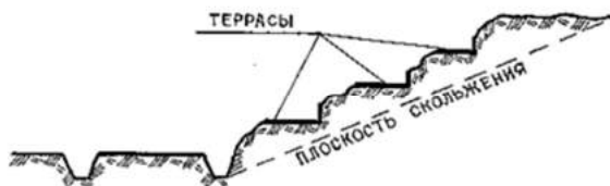
Рис. 4. Схема устройства террас для разгрузки оползневых склонов
