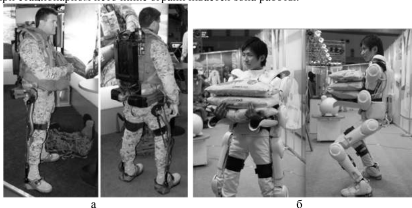
Рис. 1. Пассивный и активный экзоскелеты: а – экзоскелет HULC (США); б – экзоскелет HAL-5 (Япония)
