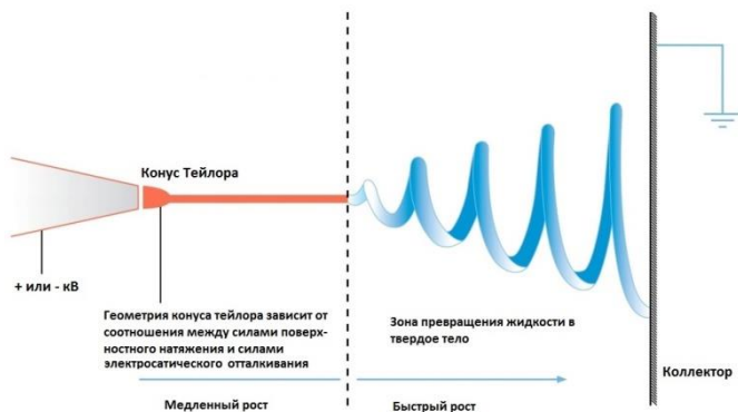
Рис. 1. Процесс электроформования волокон полимера
