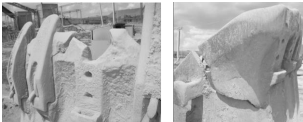
Рис. 1. Поломка передней стенки в условиях шлакоперерабатывающего предприятия
