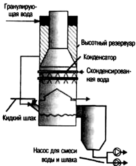
Схема башни для грануляции шлака [7]
