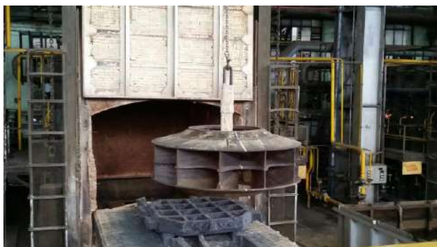
Рис. 5. Нагрев колеса крыльчатки в камерной печи перед операцией сборки
