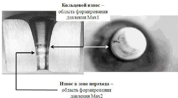
Рис. 3. Виды износов рабочей зоны волокна, формирующихся в процессе эксплуатации
