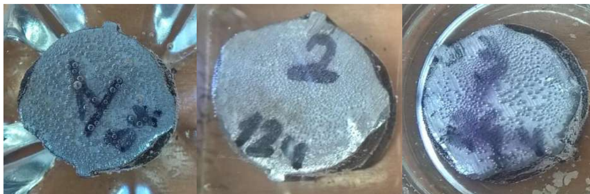
Рис. 2. Вид образцов проката, погруженных в емкость с глицерином
