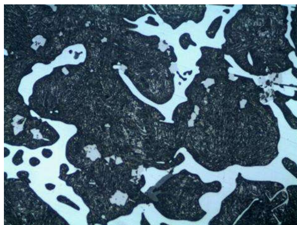
Рис. 3. Микроструктура рабочего слоя валков ICDP-GG
