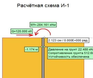
Рис. 4. Схема нагрузок на сваю
