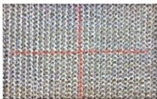
Рис. 1. Микроснимок поверхности прокатного вала, после лазерного текстурирования (100х) = 4,5 н = 160 л/см
