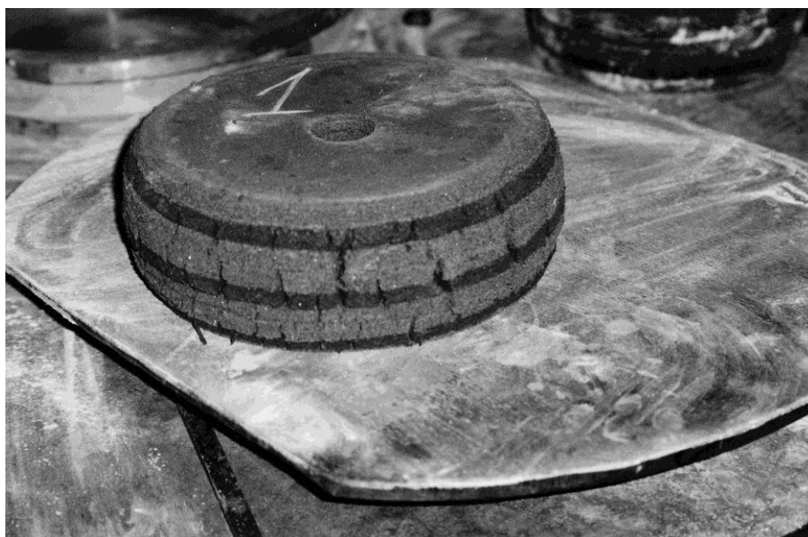
Рис.5.7. Образец, осажженный между сухими металлическими плитами с относительной деформацией \delta = 15\%
