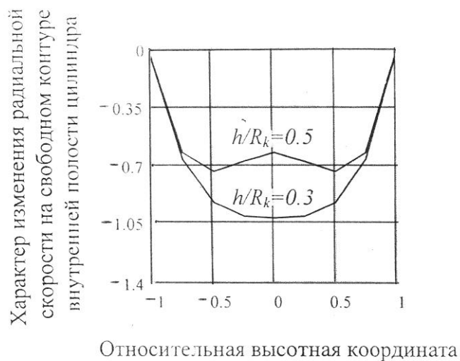
Рис. 3.19. К анализу формоизменения свободного контура внутренней полости ( \tau = 20 МПа; r_0/R_k = 0.5 )
