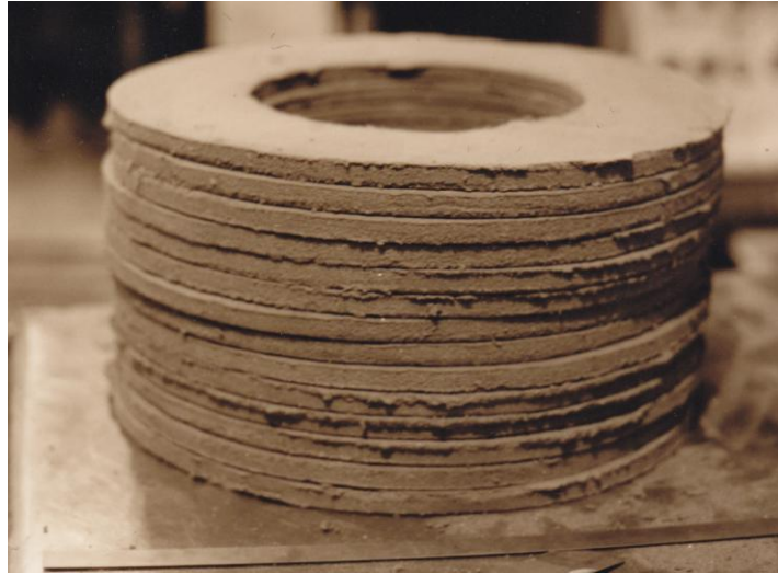
Рис.1.2. Пакет из кольцевых заготовок для прессования
