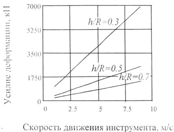
Рис. 3.6. Зависимость усилия деформации от скорости движения инструмента
