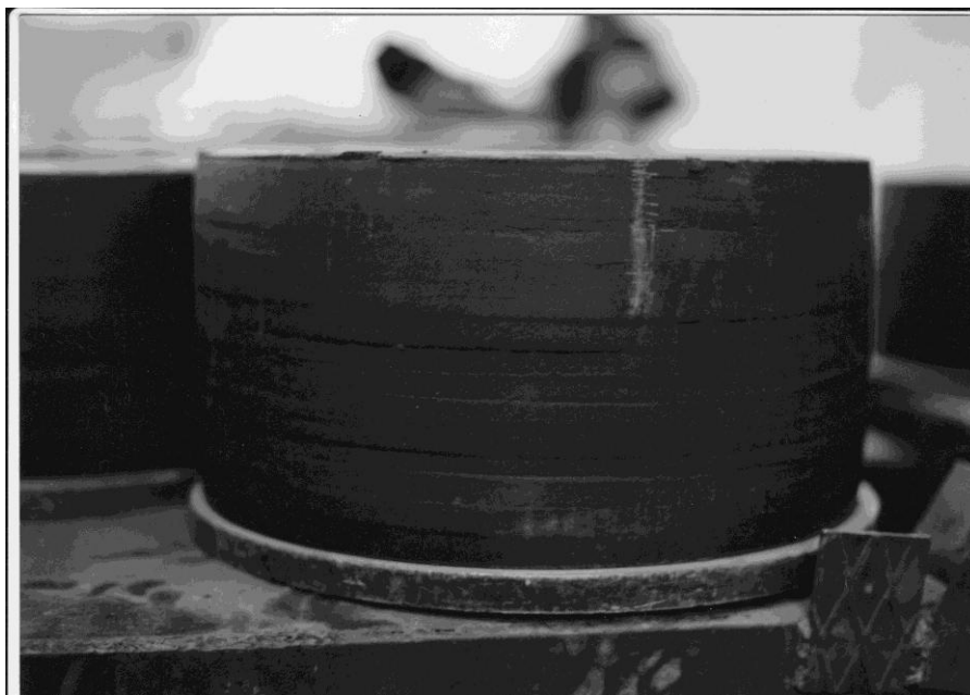
Рис.1.6. Прессовка после вулканизации
