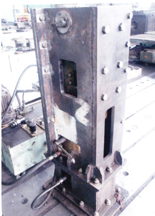
Рис.6.2. Общий вид ножниц с гидростанцией
