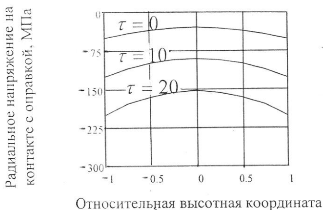
Рис. 3.11. Влияние напряжений трения на радиальные напряжения, действующие на оправку ( h/R_0 = 0.3 ; r_0/R_0 = 0.5 )
