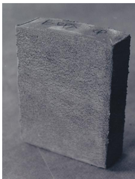
Рис.5.22. Фрагмент заготовки шлифовального круга
