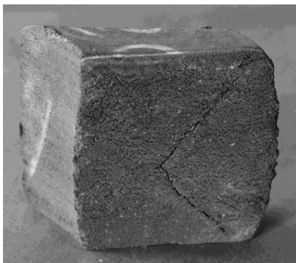
Рис.5.23. Характерные виды брака при прессовании шлифовальных кругов
