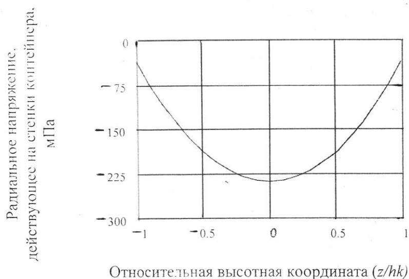
Рис. 3.24. К анализу напряженного состояния при допрессовке сплошного цилиндра
