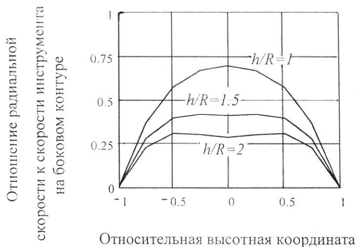
Рис. 3.3. К анализу формоизменения при осадке сплошного цилиндра
