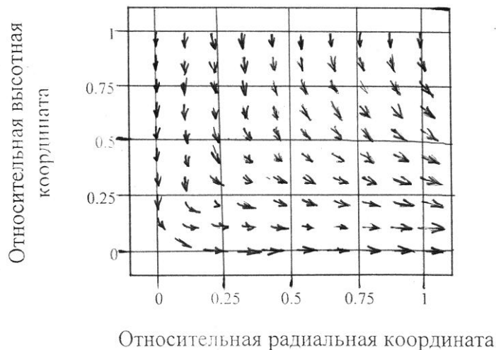
Рис. 3.5. Векторное поле скоростей перемещения материальных частиц при осадке сплошного цилиндра в условиях прилипания на контакте с инструментом ( h/R = 0,5 )
