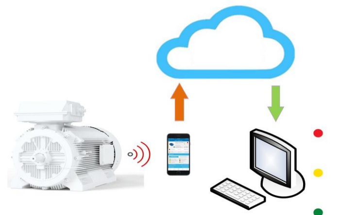
Рис. 2. Структурная схема системы мониторинга электродвигателя с помощью интеллектуального датчика
