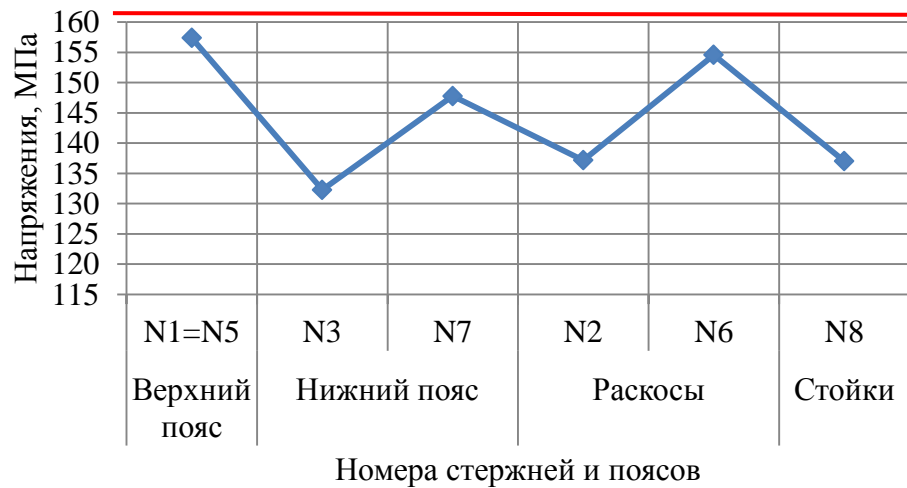
Рисунок 3.43 – Ферма: L = 18 м; d = 3 м; h = 2 м (красная линия - \sigma_T = 165 МПа)
