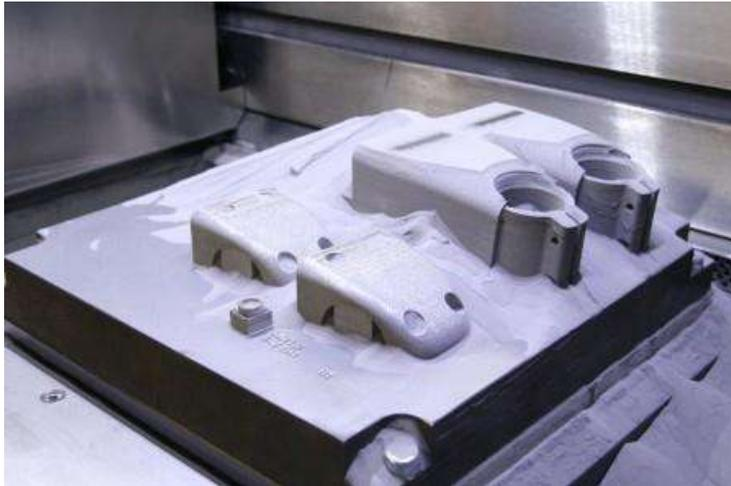
Рисунок 4. Детали напечатанные методом Direct metal laser sintering
