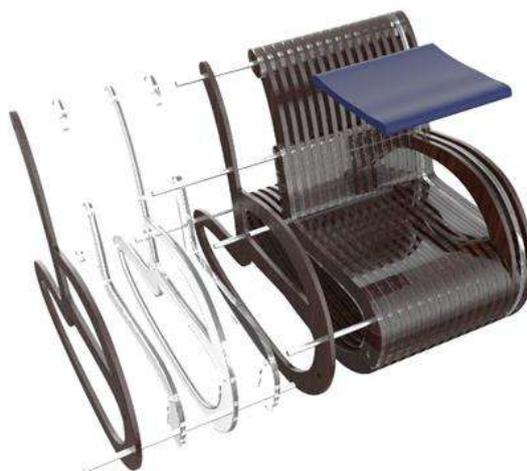
Рисунок 2. Параметрическая мебель из комбинированных материалов
