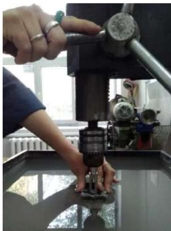
Рисунок 11. Сверление заготовки кольца
