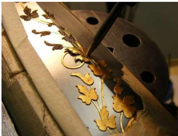
Рисунок 2. Технология выполнения насечки латунных элементов на поверхности клинка.
