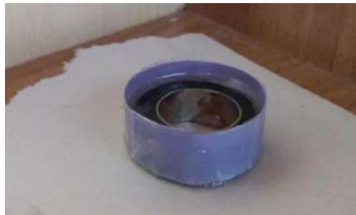
Рисунок 16. Заливка заготовки кольца эпоксидной смолой
