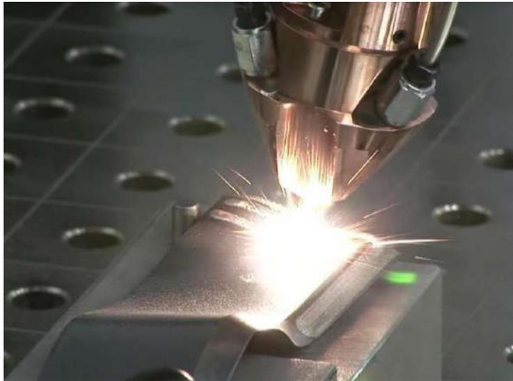
Рисунок 6. Процесс 3d-печати металлом
