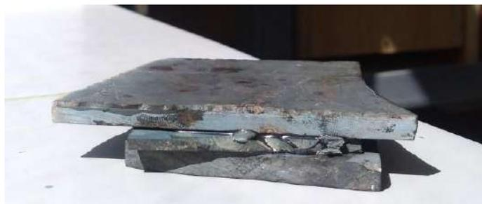
Рисунок 17. Склеенные слои заготовок кольца
