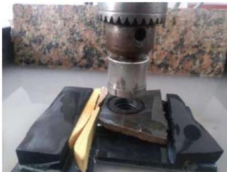
Рисунок 18. Сверление заготовки кольца
