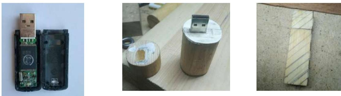
Рисунок 1. Процесс подготовки USB-флеш-накопителя для декорирования
