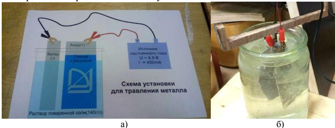
Рисунок 4. Травление медных пластин: а – схема установки для травления металла, б – процесс травления
