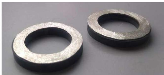
Рисунок 12. Склеенные заготовки кольца
