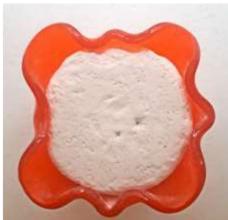
Рисунок 3 - Плафон, полученный моллированием заготовки диаметром 260 мм (вид снизу)
