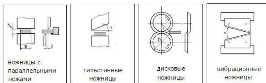
Рисунок 5 – Схемы резки листового материала
