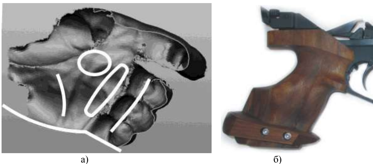
Рисунок 2 – Анализ формы кисти руки по 3D-скану (а) рукоятка выполненная с учетом анатомии кисти руки (б)
