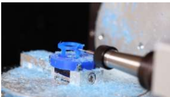
Рисунок 5 - Изготовление восковки на ЧПУ фрезере
