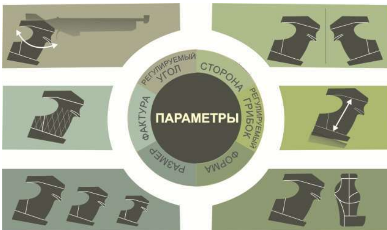
Рисунок 5 – Параметры рукоятки, влияющие на удобство удержания пистолета
