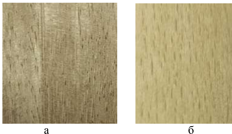
Рисунок 3 - Образцы отбеленного шпона: а) из древесины красного дерева, б) из древесины бука
