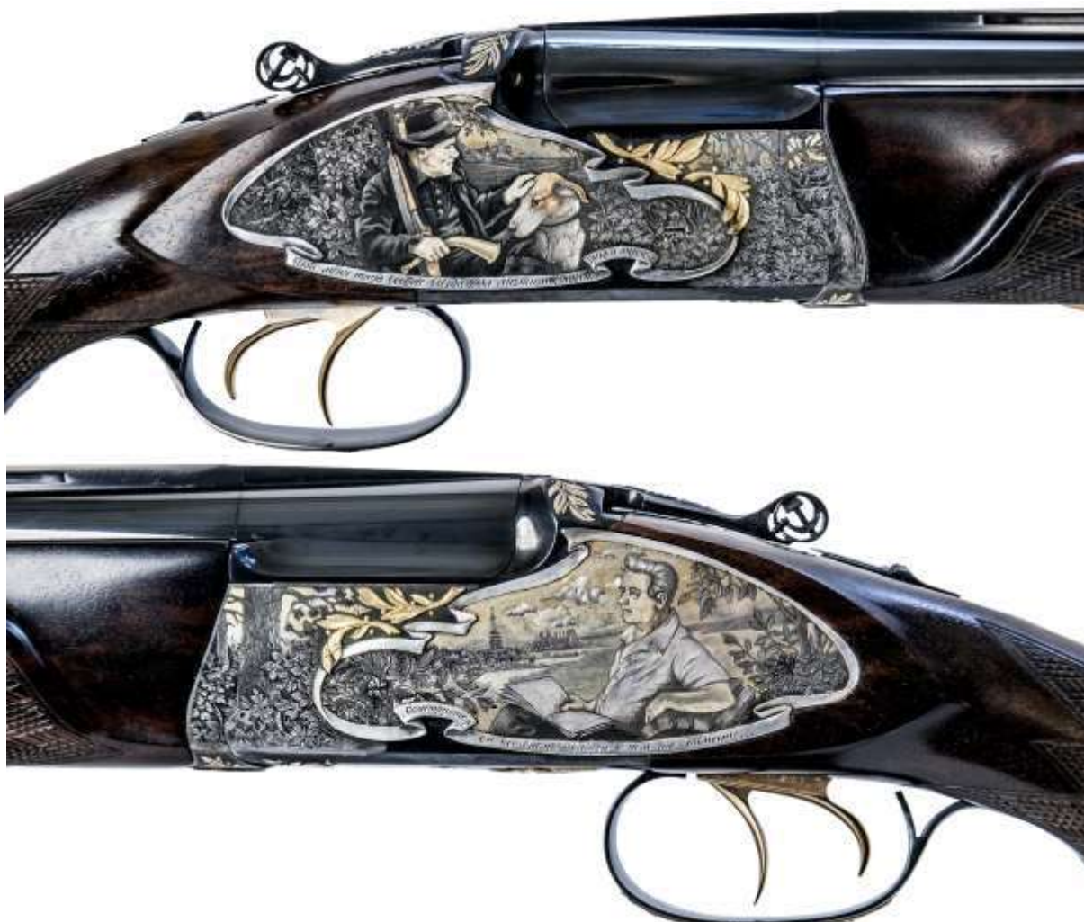
Рисунок 11-12 - Большая часть оформления выполнена инкрустацией драгоценных металлов и сплавов по технологии «ласточкин хвост»
