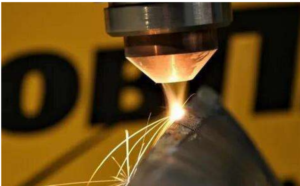
Рисунок 3. Лазерная резка алюминия
