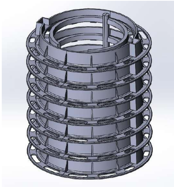
Рисунок 3. 3D модель готовой отливки корпуса люка
