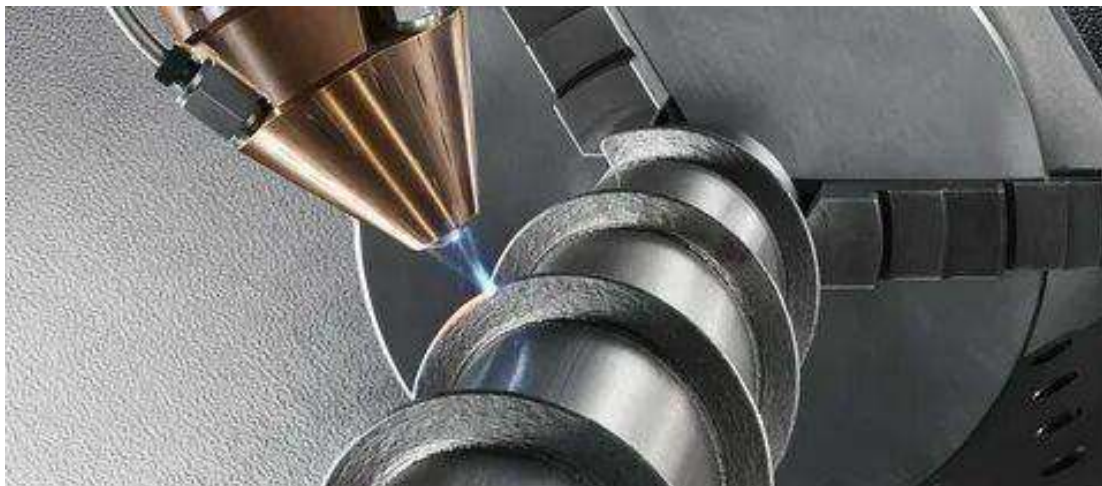
Рисунок 1. Прямая лазерная наплавка металла
