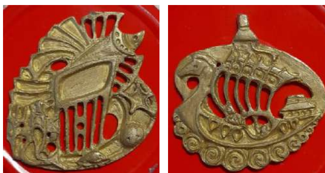
Рисунок 5. Латунные отливки накладки для броши и подвески
