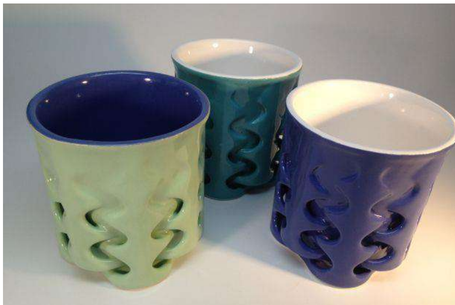
Рисунок 2. Изделия, изготовленные на 3D-принтере CeraJet
