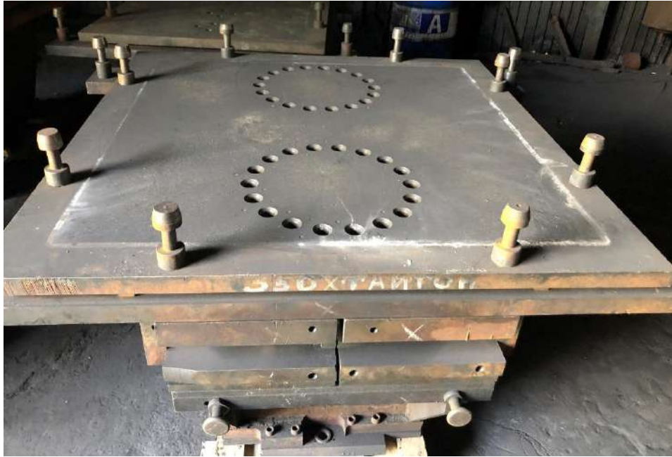
Рис. 2. Лемповский ящик в сборе
