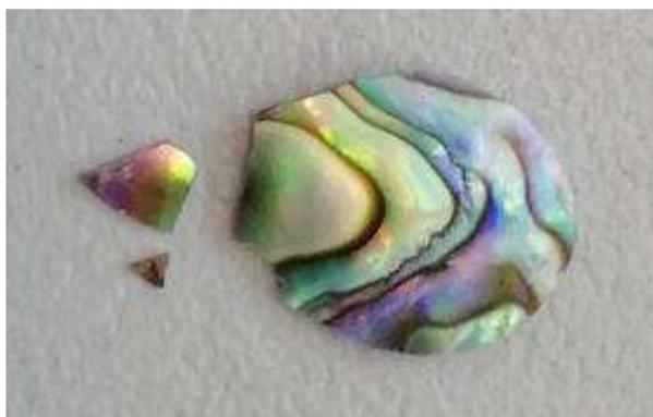
Рисунок 3. Лопнувшая заготовка
