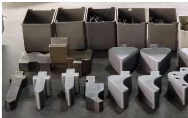
Рисунок 2. Пример 3D-печати формовочной оснастки: ножи для формовки из PLA
