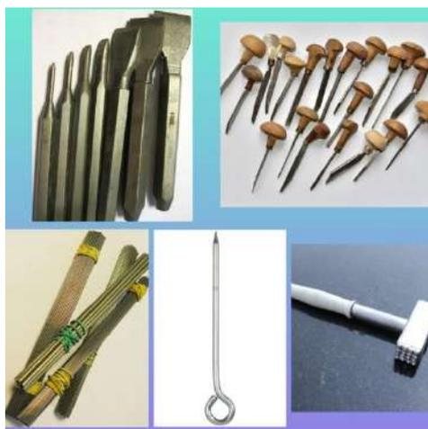
Рисунок 4. Инструменты для ручной гравировки
