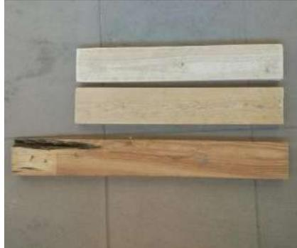
Рисунок 4. Необработанный не распиленный материал и распиленная и обработанная доска
