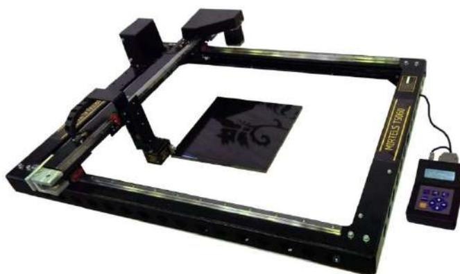
Рисунок 6. Механический гравировальный станок
