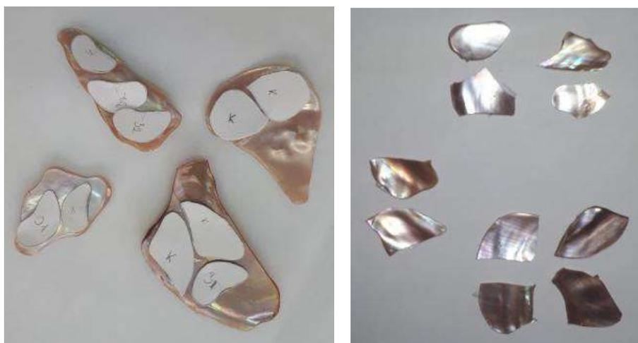
Рисунок 3. Распил заготовок перламутра
