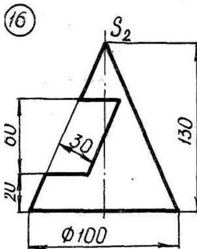
Контрольная работа письменная к защите задания «Построение проекций поверхности со сквозным вырезом»
