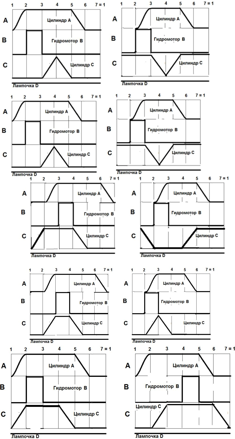
**Задание 2.** Согласно заданной диаграммы перемещения разработать системы управления: 1 - используя релейно-контактные схемы; 2 - используя (симулятор) контроллера в программе FluidSim-H.
