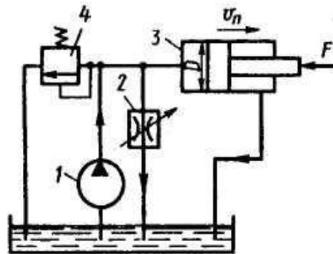
На рисунке показана упрощенная схема объемного гидропривода поступательного движения с дроссельным регулированием скорости выходного звена (штока), где 1 - насос, 2 - регулируемый дроссель. Шток гидроцилиндра 3 нагружен силой  $F = 1200 \text{ Н}$ ; диаметр
