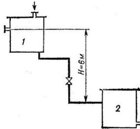
Подобрать необходимый диаметр цилиндрического насадка ( $\mu=0,82$ ) с таким расчетом, чтобы через него вытекало 77000 кг/ч нефти плотностью  $865 \text{ кг/м}^3$ . Напор  $H$  постоянный и равен 12 м.
