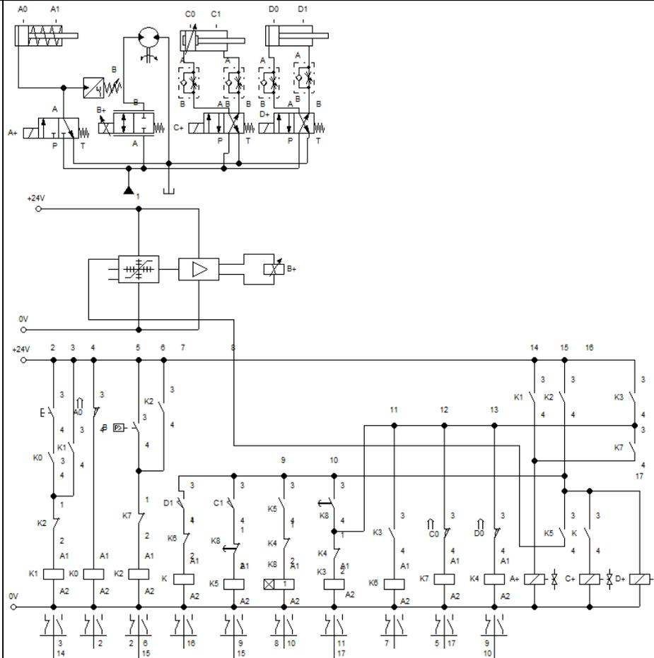
**Задание.** Постройте диаграмму «перемещение-шаг» для заданной системы управления гидроприводом (1 гидромотор и 3 гидроцилиндра)
