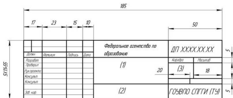
Рисунок 1 Основная надпись на горных чертежах
