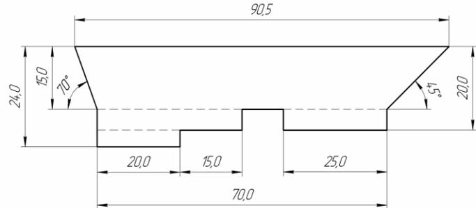
Рис. Проектные размеры котлована в разрезе
