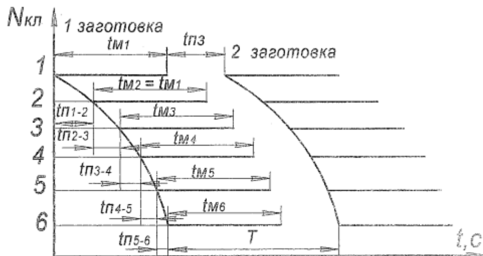
Рис. 3.1. График прокатки на непрерывном стане
