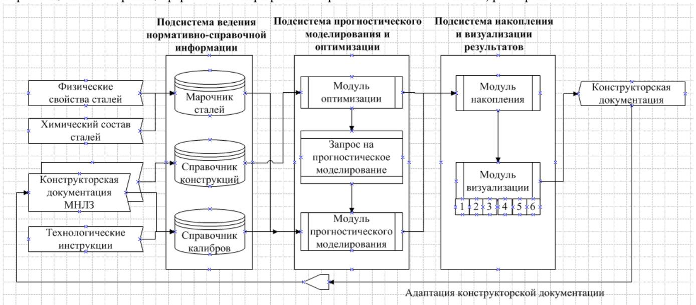
Рис. 5. Схема построения системы автоматизации проектирования
